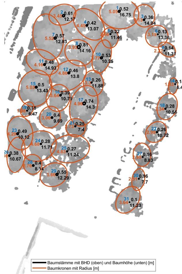
Abbildung 2.1: Ergebnisse der Extraktion von Baumparametern aus einem 2D-Rasterbild mittels Bildverarbeitung [Zintl, 2021].
