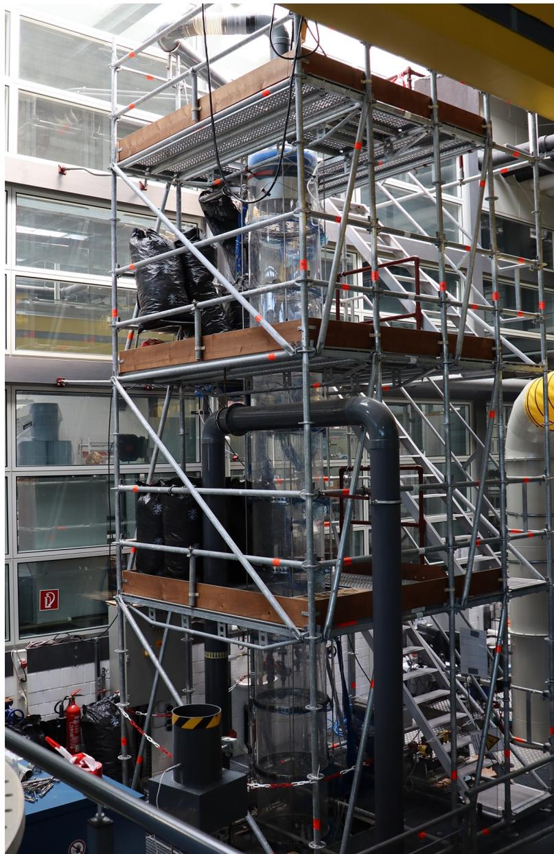
Abbildung 3.1: Die  $\varnothing 0.634$  m-Kolonne in der Peripherie des Technikums.
