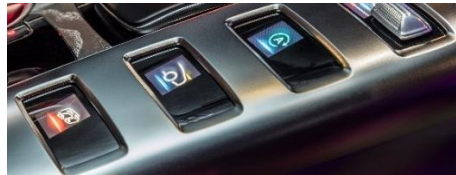
Abbildung 4.3: Anwendungsbeispiel kapazitiver Tasten mit hinterlegtem Display des Automobilherstellers Mercedes-Benz AG [167]
