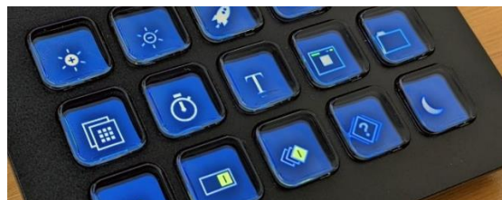
Abbildung 4.2: Anwendungsbeispiel von Displaytastern aus dem Consumer-Electronics-Bereich des Herstellers Elgato [165]
