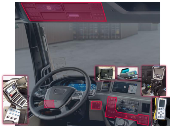
Abbildung 1.1: Lkw-Fahrer Arbeitsplatz mit zusätzlich verbauten Bedienteilen für Aufbaufunktionen und rot markierten Bedienorten für Fahrzeugfunktionen [4]
