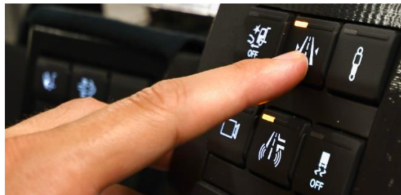
Abbildung 6.5: Physische Hubtaster der statischen MMS mit haptischer Abtrennung durch Fühlstege zwischen den Tasten sowie LED-Leuchte zur Rückmeldung des Funktionsstatus
