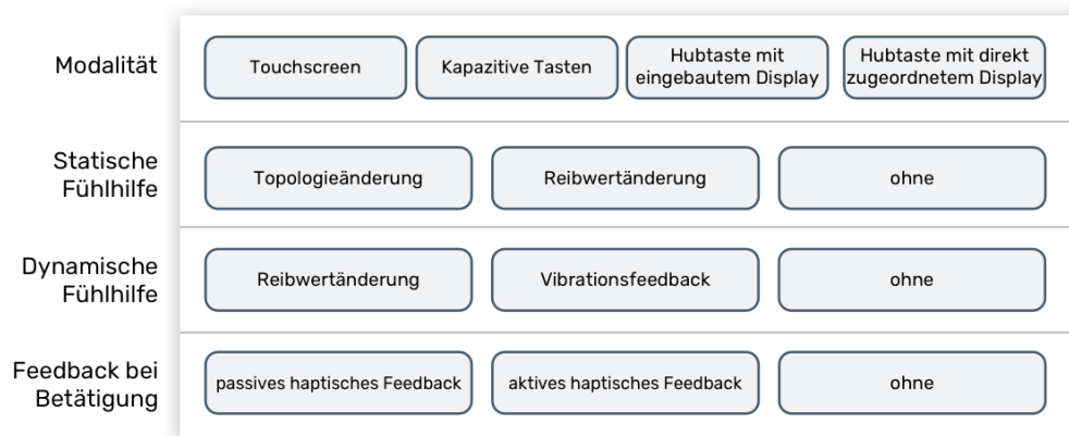
Abbildung 4.14: Nach VDI Richtlinie 2222 Blatt 1 [220] und Zwicky [219] aufgebauter morphologischer Kasten mit Eigenschaften und deren mögliche Ausprägungen für Bedienhardwarekonzepte
