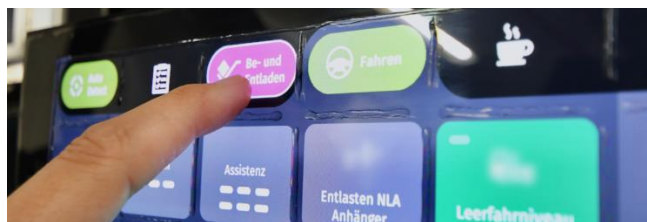
Abbildung 6.4: Prototypische Umsetzung der adaptiven MMS mit haptischem Touchdisplay und auf der Displayoberfläche aufgetragenen Fühlstegen
