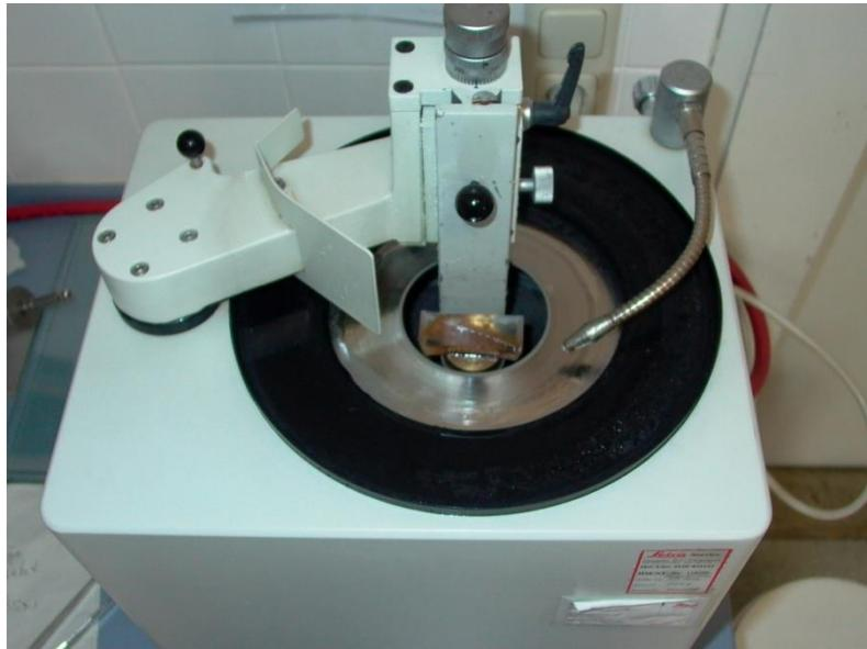
Abb. 11:Knochensäge *FK23 Bizerba* mit eingespanntem Schnittpräparat
