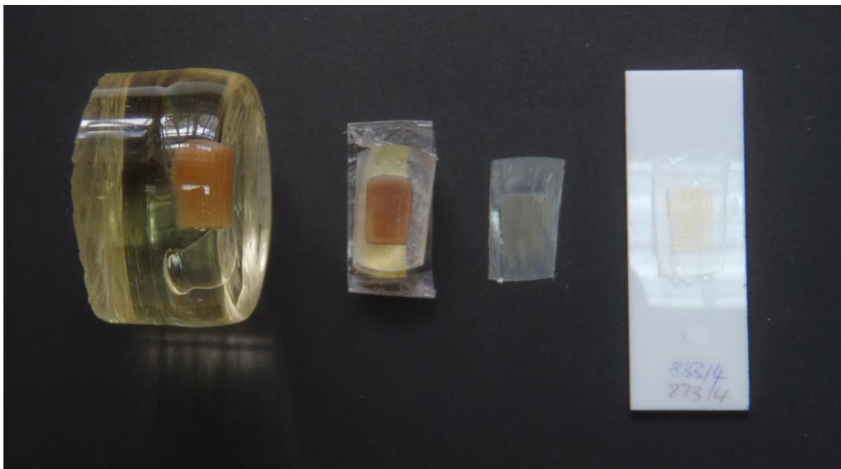
Abb. 12: Methylmethacrylat- Block, zugetrimmte MMA-Probe, MMA-Schnitt, Objektträger mit Schnitt
