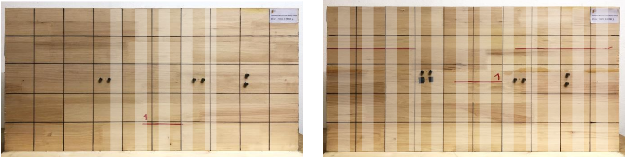
Abbildung 3.24: Prüfkörper M-3-1 (links) und M-3-2 (rechts) nach der Heizphase, mit angezeichnetem Riss und farblicher Markierung der Luftkanäle
