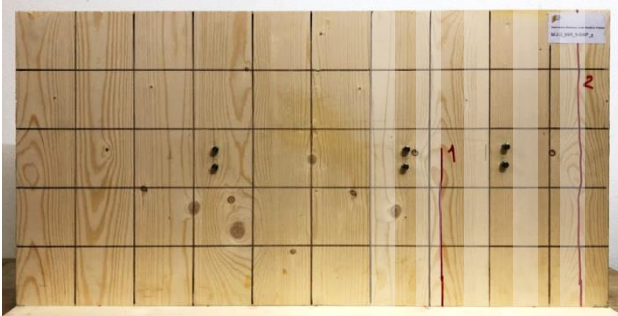
Abbildung 3.22: Prüfkörper M-2-2 nach der Heizphase, mit angezeichneten Rissen und farblicher Markierung der Luftkanäle
