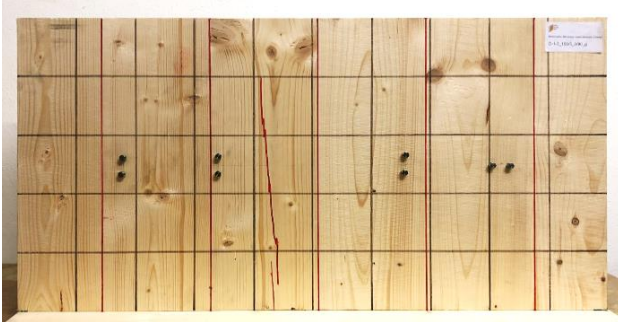
Abbildung 3.28: Prüfkörper O-1-3 (V) nach der Heizphase, mit angezeichneten Rissen
