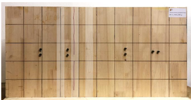
Abbildung 3.21: Prüfkörper M-1-3 (V) nach der Heizphase, mit angezeichneten Rissen und farblicher Markierung der Luftkanäle
