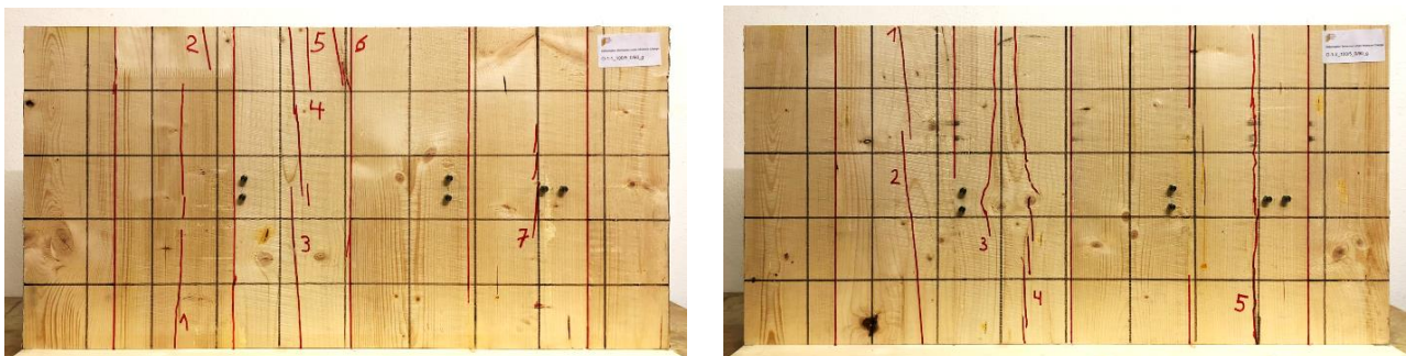
Abbildung 3.27: Prüfkörper O-1-1 (links) und O-1-2 (rechts) nach der Heizphase, mit angezeichnetem Riss und farblicher Markierung der Luftkanäle
