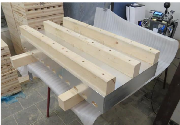
Abbildung 3.7: Vorbereitung der Prüfkörper mit diffusionsdichter Aluminiumfolie und Verformungsbehinderung
