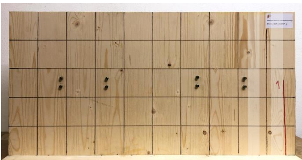
Abbildung 3.23: Prüfkörper M-2-3 (V) nach der Heizphase, mit angezeichneten Rissen und farblicher Markierung der Luftkanäle
