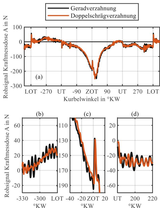
**Abb. 11** Rohsignal einer Kraftmessdose. *Oben:* Gesamtes Arbeitsspiel. *Unten:* drei Bereiche des Arbeitsspiels. Vergleich des Schwingungseinflusses der Riementriebe am Betriebspunkt 2000 1/min und 6 bar  $p_{mi}$
