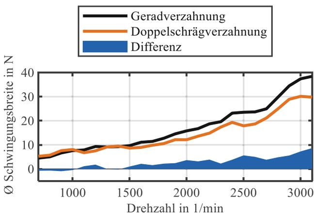
Abb. 8 Mittlere Schwingungsbreite der Riemensysteme im geschleppten Betrieb
