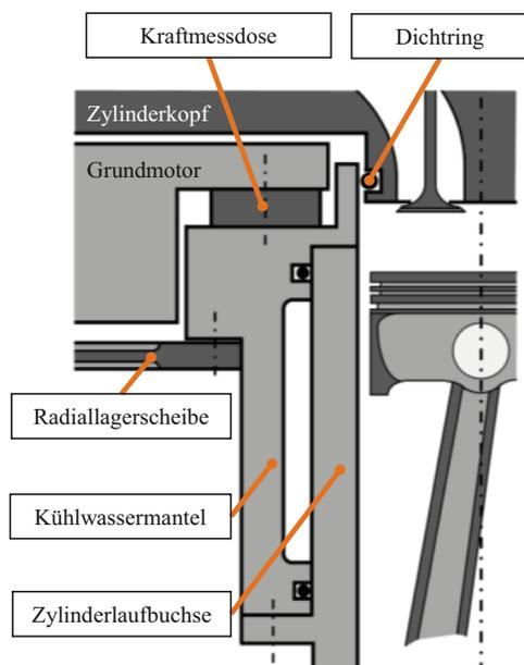
**Abb. 6** Floating-Liner Methode nach [17]
