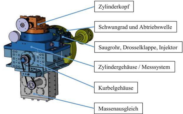
Abb. 5 Forschungsmotor zur Reibkraftmessung
