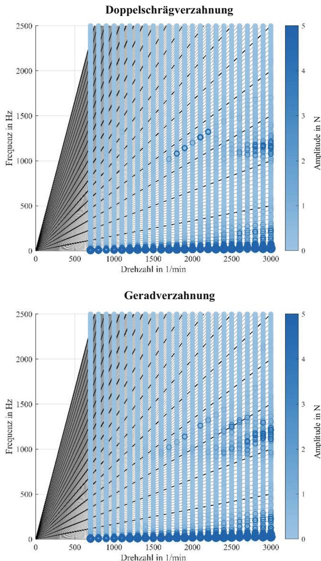
**Abb. 9** Campbell-Diagramme der Riementriebe. Unten: Geradverzahnung. Oben: Doppelschrägverzahnung
