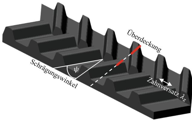
Abb. 3 Ausschnitt des doppelschrägverzahnten Riemen mit Schrägungswinkel, Zahnversatz und Überdeckung
