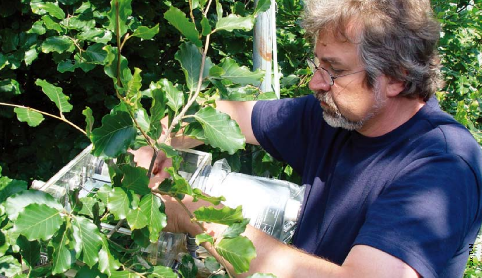
Thomas Feuerbach setzt mehrere Buchenblätter in die klimatisierte Messküvette ein
