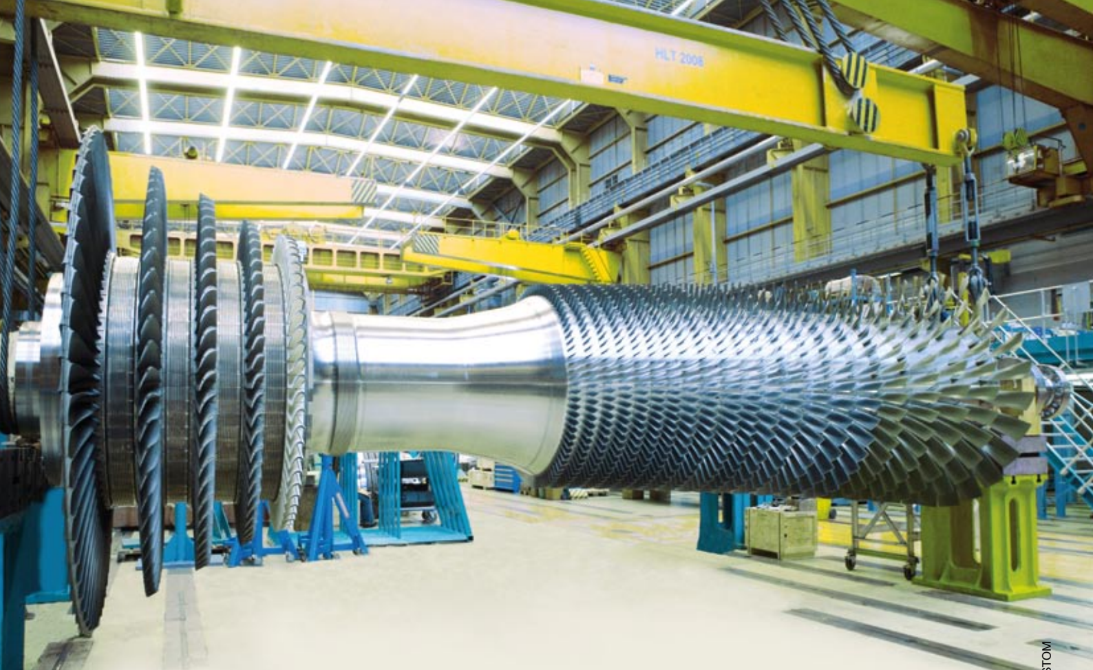
Rotor einer Kraftwerksgasturbine mit etwa 280 Megawatt Leistung. Dazwischen befindet sich nach dem Zusammenbau die Ringbrennkammer, wo der Brennstoff mit der auf etwa 20 bar verdichteten Luft mit einer Gesamtleistung von rund 700 MW verbrannt wird
