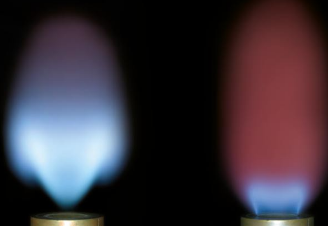
Flammen im Versuchsbrenner (vgl. Seite 12): links eine Erdgasflamme, rechts eine Wasserstoffflamme, jeweils bei 50 Kilowatt Leistung. Daran untersuchen die Forscher unter anderem den Einfluss von Gemischbildung und Druck auf die Neigung zu Flammenrückschlägen
