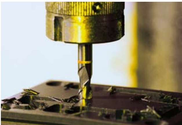
Die Werkzeugmaschine bohrt die Gänge des Labyrinths in den Kunststoff
