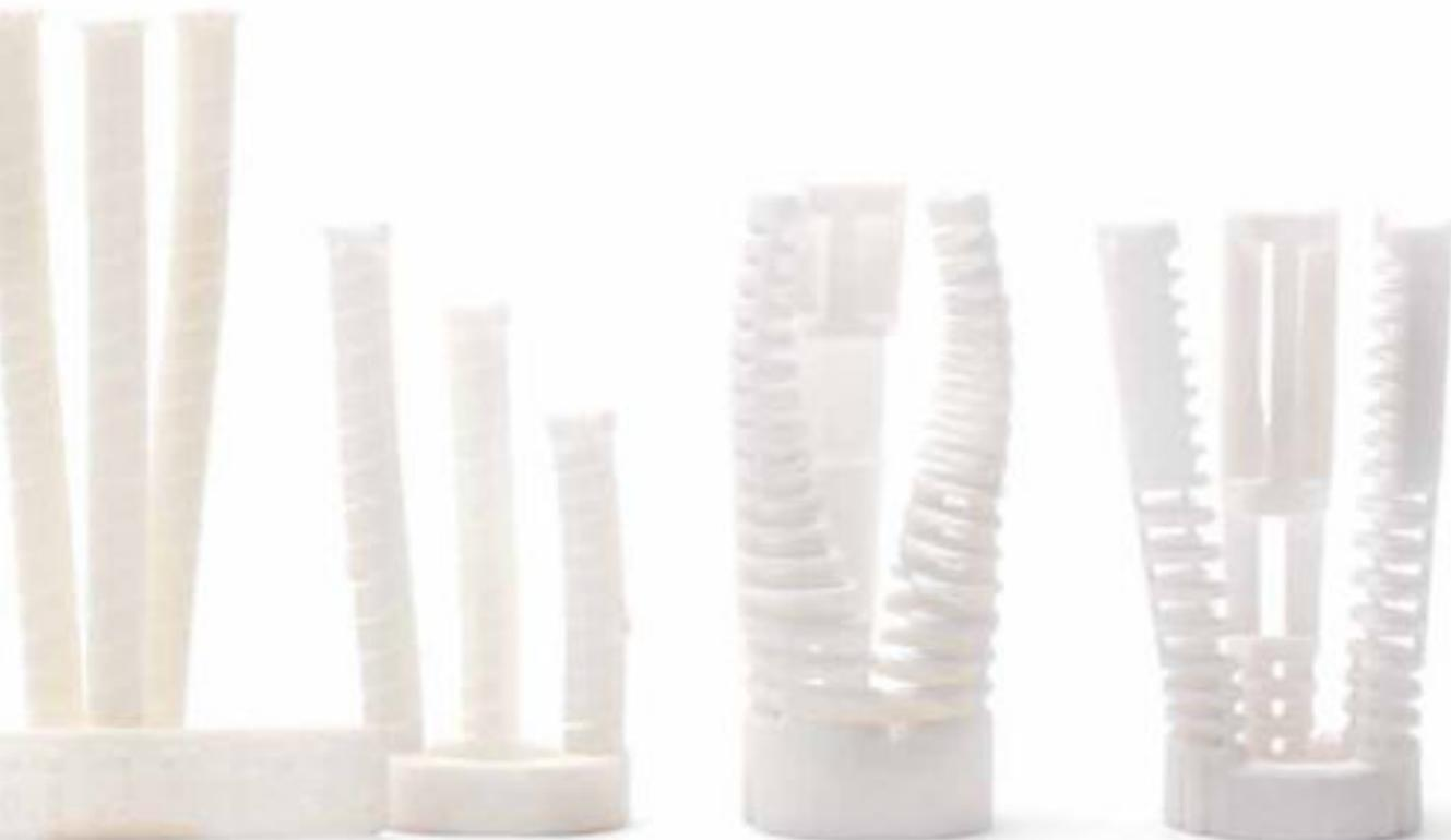
Deshalb haben die Forscher beschlossen, ein Exoskelett um den Endoskopschlauch herum zu bauen, denn „wenn man etwas nicht innen unterbringen kann, muss man es eben außen entlangführen“, erklärt Gumprecht. In dieser Hülle verlaufen weitere Kanäle, in denen die Steuerung für die Instrumente angebracht ist. Heute erproben die Wissenschaftler das Ganze noch mit den Fäden, später sollen diese durch feine Schubstangen ersetzt werden.
