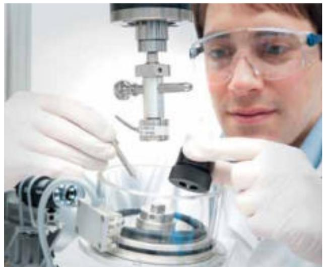
Constantin von Deimling vermisst mit einem Robotersystem alle möglichen Bewegungen von Gelenken und ihre jeweilige Belastung – hier an einem Schweineknie / Constantin von Deimling uses a robotic system to measure all the possible movements of a joint and their individual impact – here with a pig's knee
