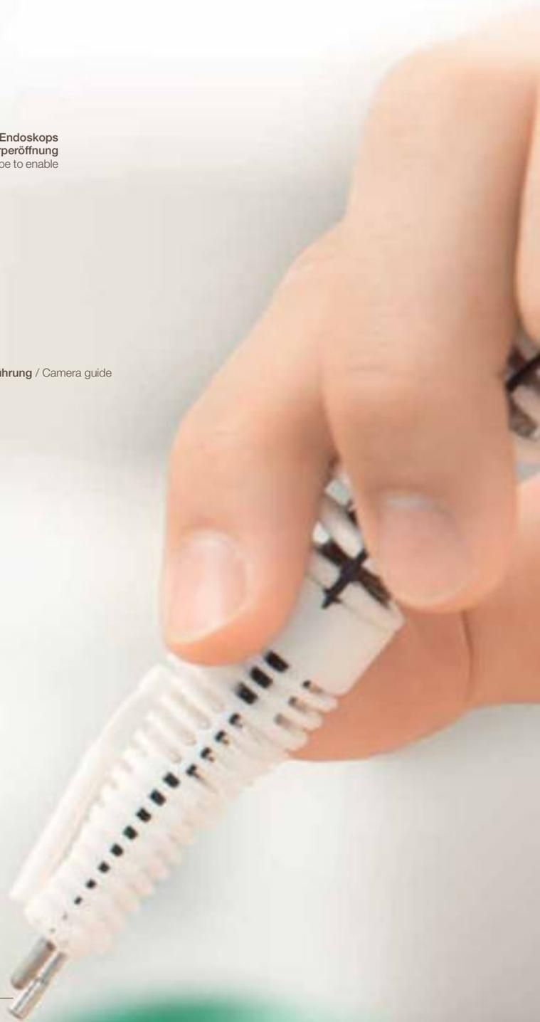
Das Endoskop wird über die Speiseröhre eingeführt. Seine drei Arme enthalten eine Kamera und zwei Instrumente, die zusammenarbeiten können / The endoscope is inserted through the esophagus. Its three arms contain a camera and two surgical instruments that can be operated together
