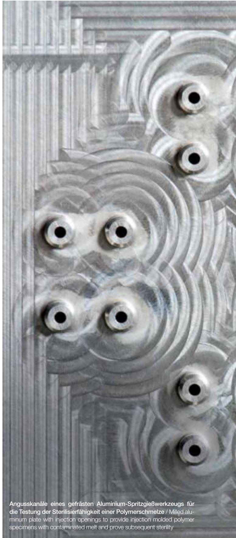
Angusskanäle eines gefrästen Aluminium-Spritzgießwerkzeugs für die Testung der Sterilisierfähigkeit einer Polymerschmelze / Milled aluminum plate with injection openings to provide injection molded polymer specimens with contaminated melt and prove subsequent sterility
