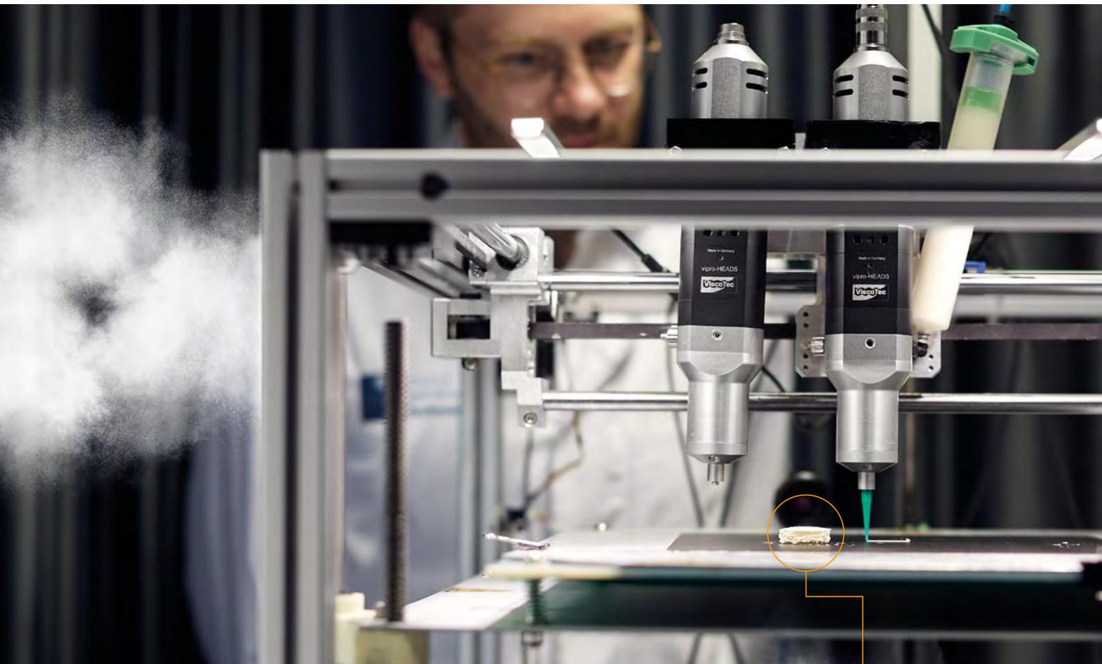
Drei Jahre haben die Forscher daran gearbeitet, die Druckbarkeit von Teig zu erforschen und den Prozess zu optimieren. „Eine große Herausforderung lag darin, den Teig gleichmäßig aufzutragen: Die zähe und elastische Masse aus Mehl und Wasser muss durch einen Trichter, den Applikator, gepresst werden, ohne dass die knapp einen Millimeter dünne Öffnung verstopft“, berichtet Jekle. Er leitet die Arbeitsgruppe Getreidetechnologie und -verfahrenstechnik am Lehrstuhl.
