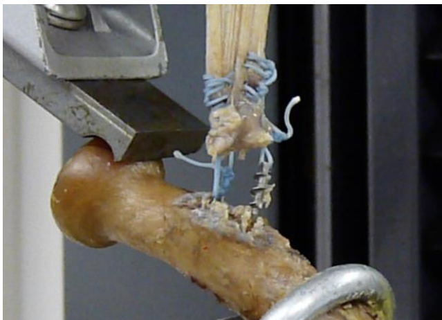
Abbildung 29: Beispiel Foto eines knöchern ausgerissenen Fadenanker
