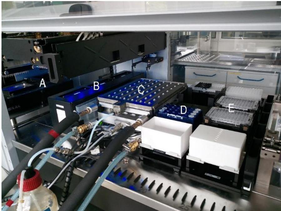
**Abbildung 4:** 48 Rührkesselreaktoren im mL-Maßstab automatisiert durch einen Pipettierroboter. Bei (A) Mikrotiterplattenlese- sowie -waschgerät (B) Nadelwaschstation mit drei Waschstationen und Nadelsätzen (C) Bioreaktorblock mit 48 parallel betriebenen Rührreaktoren (D) vom Roboter selbstständig zu öffnende Reaktionsgefäße („FlipTubes“) (E) für at-line Messungen verwendete Mikrotiterplatten
