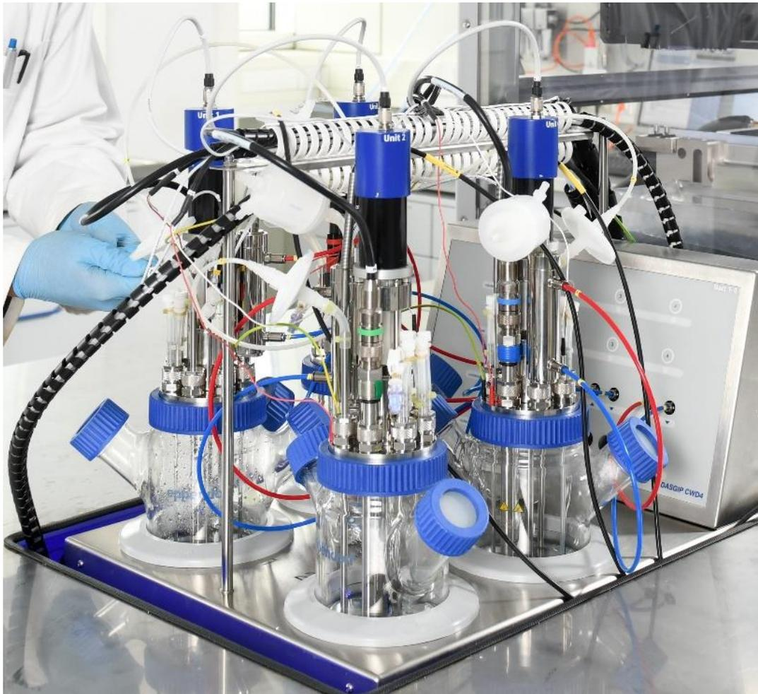
**Abbildung 3:** Foto des Parallelreaktorsystems im L-Maßstab. Jeder Glasrührkesselreaktor befindet sich in einem einzeln temperierbaren Mantel. Der Motor, Dosierstrecken sowie die Sonden (pH, pO<sub>2</sub>) werden im Reaktordeckel montiert.
