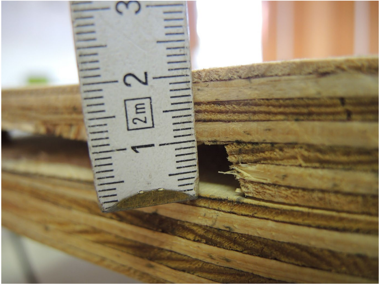
Abb.1.2-20: Bemusterung der Fledermausbohlen, Spaltenbreite hinten (Bild: Sylvia Weber, LBV)
