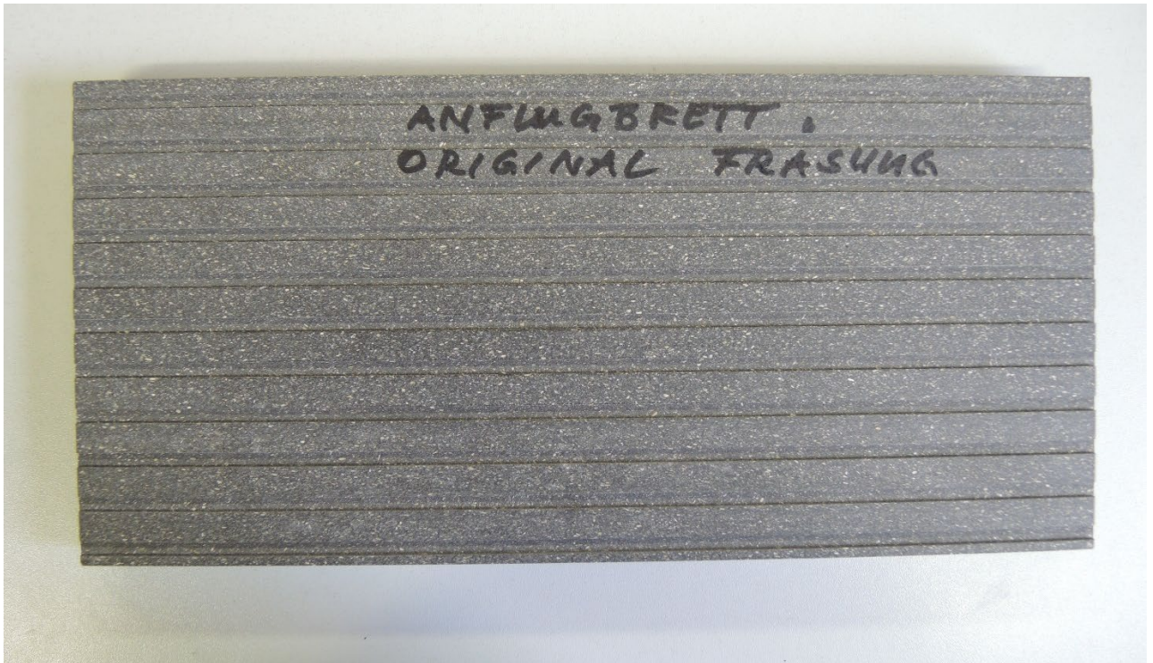
Abb. 1.2-7: Prüfung der Fräsrillen an den WPC-Platten der Anflugbretter der Mehr- und Einkammerkästen für Fledermäuse (Bild: Sylvia Weber, LBV)
