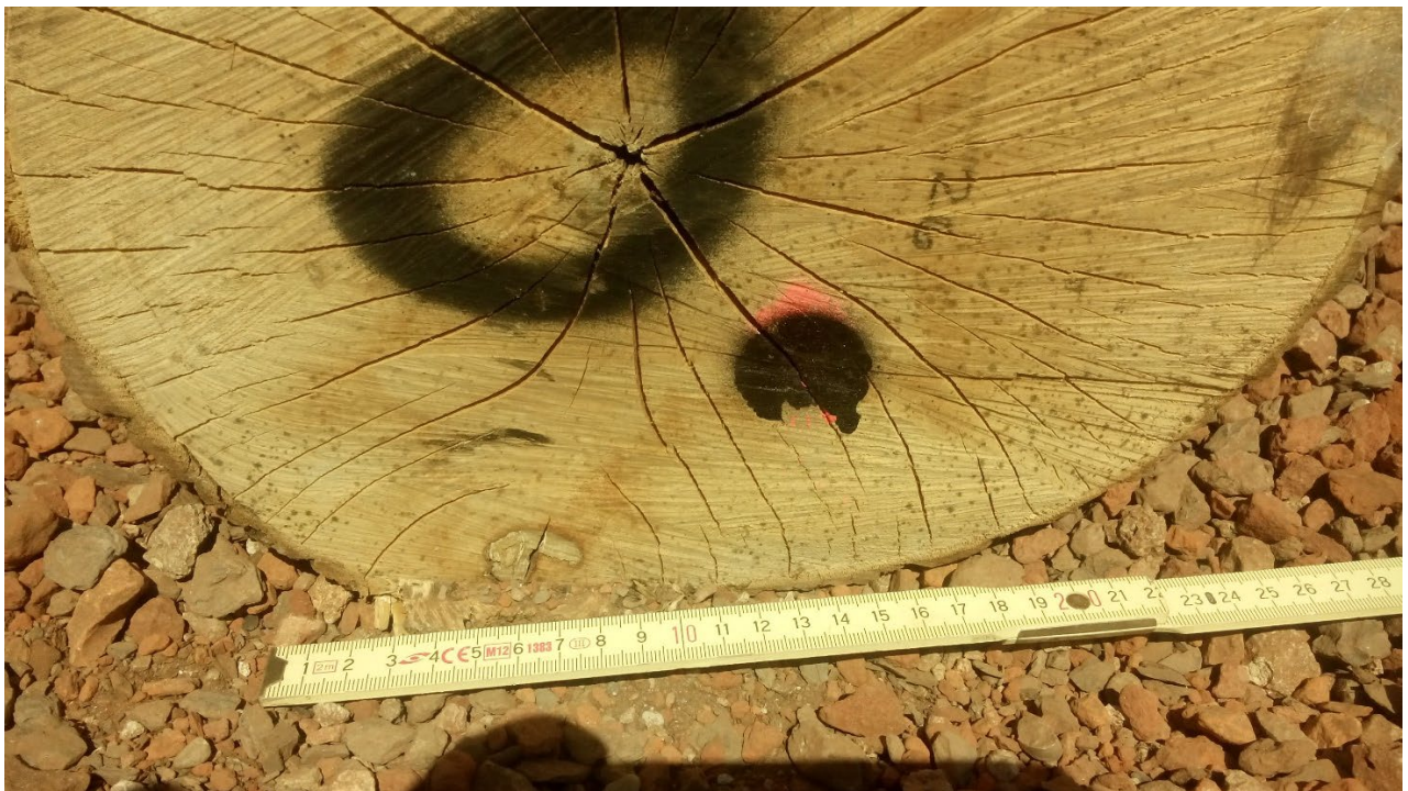
Abb. 2.5-10: Dokumentation der Auflagefläche eines Holzsheits auf einer Versuchsfläche in der Brantstraße (Bild: Maximilian Mühlbauer)
