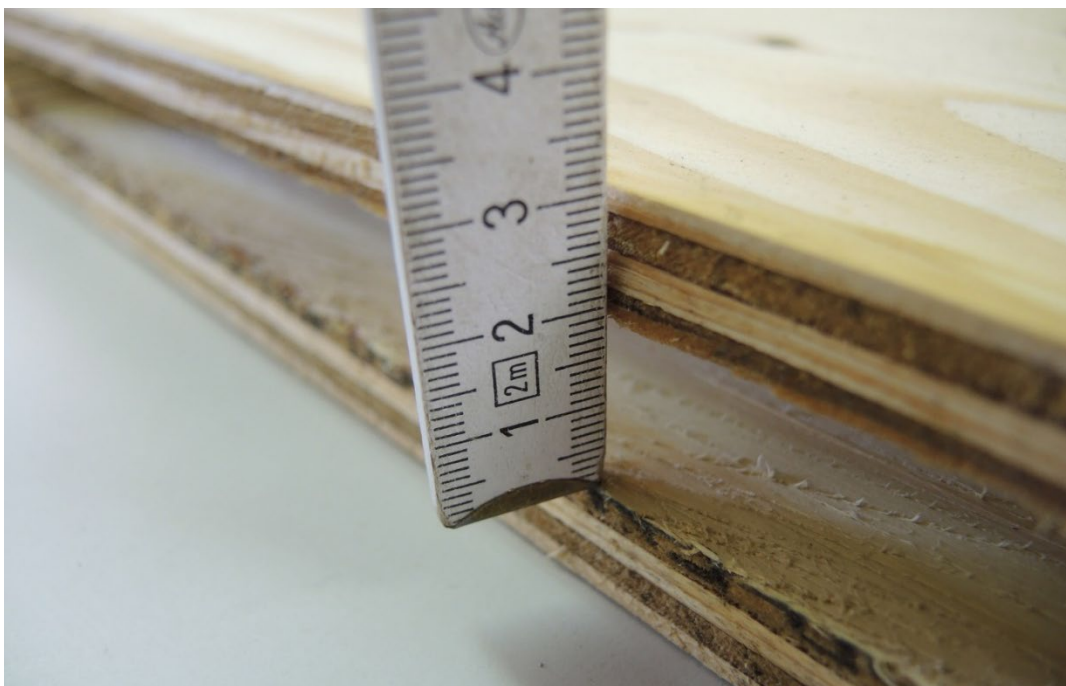
Abb. 1.2-21: Bemusterung Fledermausbohlen, Spaltenbreite vorne (Bild: Sylvia Weber, LBV)
