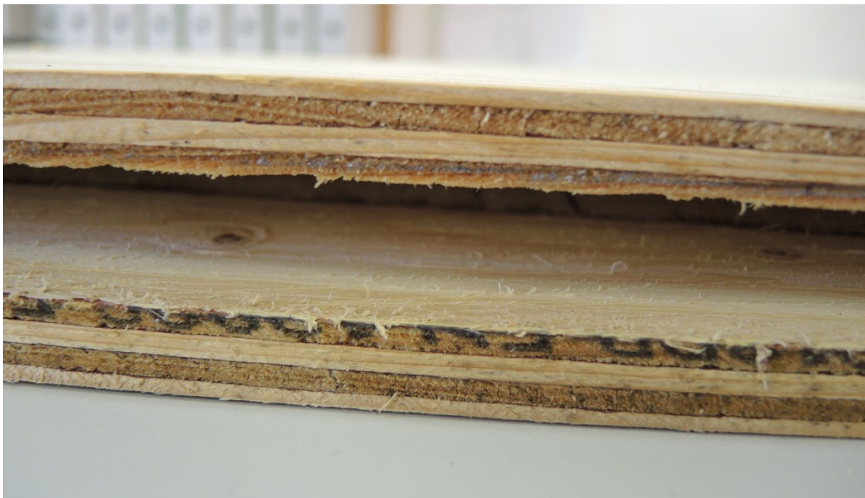
Abb. 1.2-19: Bemusterung der aufgerauten Hangflächen an den Fledermausbohlen (Bild: Sylvia Weber, LBV)
