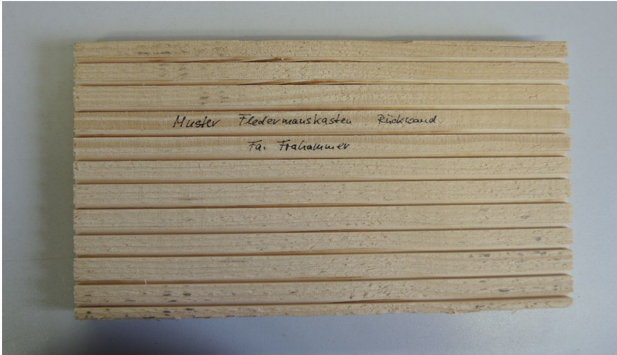
Abb. 1.2-8 : Prüfung der Fräsillen an den Rückwänden der Mehr- und Einkammerkästen für Fledermäuse (Bild: Sylvia Weber, LBV)
