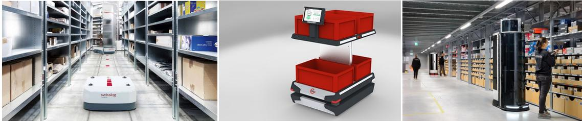
Abbildung 3-4: Mobile Roboter in der Kommissionierung; links: RMFC [Swi-o.J.], Mitte: PSA [Geb-o.J.], rechts: MPR [Mag-2019]
