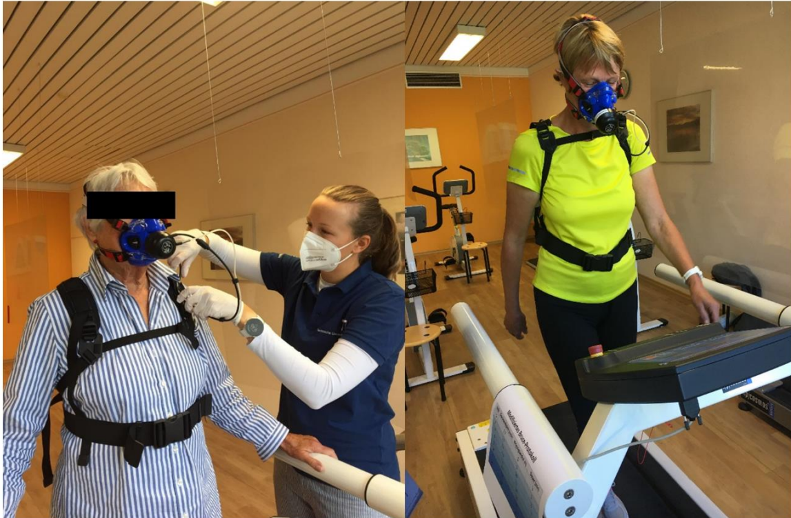
Abbildung 24: Vorbereitung einer Probandin für den Laufbandtest durch das Anlegen der mobilen Spiroergometrie durch die Doktorandin (links). Probandin während des Ausbelastungstests auf dem Laufband mit mobiler Spiroergometrie (rechts) (Fotos: Laura Eisenberger)
