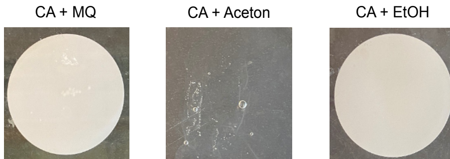
Abbildung 20. Analyse der Wirkung von Aceton auf Membranen aus Celluloseacetat (CA).
