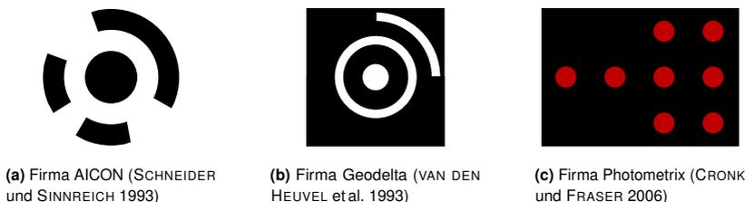
**Abbildung 3.5:** Exemplarische Zielmarkensysteme aus dem Bereich der optischen Messtechnik (in Anlehnung an SHORTIS und SEAGER 2014)
