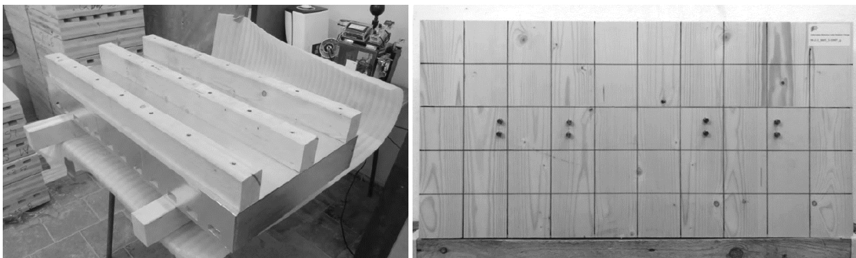
Abbildung 16: Vorbereitung der Prüfkörper mit diffusionsdichter Aluminiumfolie und Einschlag-Elektrodenpaare
