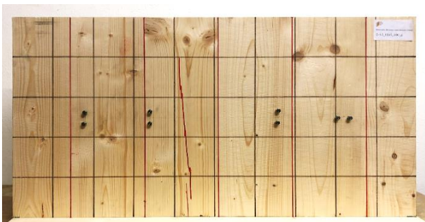
Abbildung A11: Rissbild Prüfkörper O-1-3 (V)
