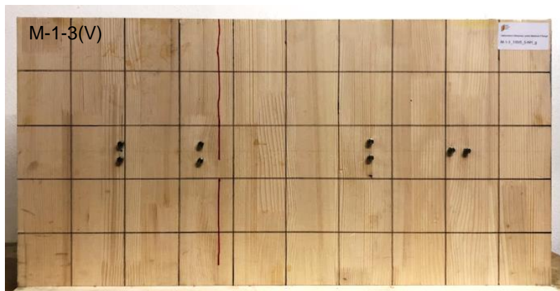
Abbildung 25: Exemplarisches Rissbild in der Außenlage des Prüfkörpers M-1-3(V) nach Phase 3
