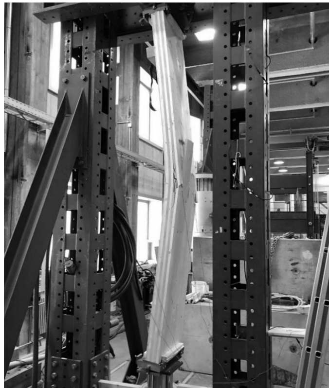
Abbildung 9: Versuchsaufbau der Knickversuche am multifunktionalen CLT [mm]
