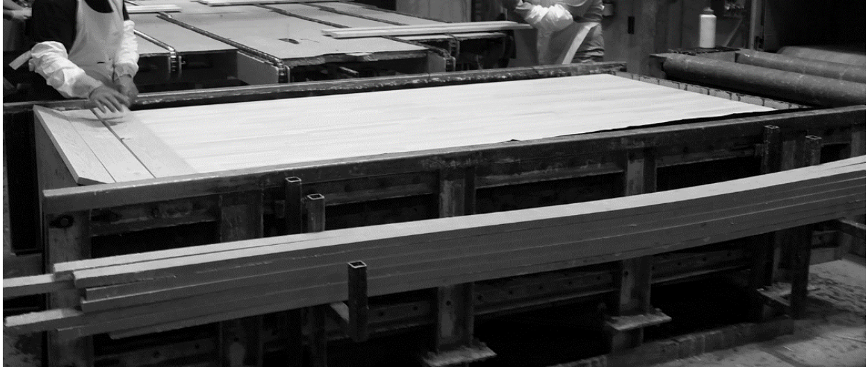
2. Schritt: Herstellung der Funktions- und Decklagen
