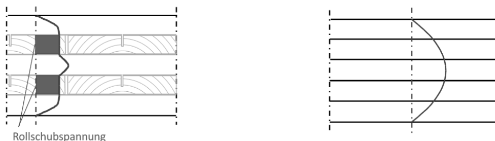
Abbildung 53: Vergleich der Schubspannungen zwischen Brettsperrholz (links) und Brett-schichtholz (rechts) [6]
