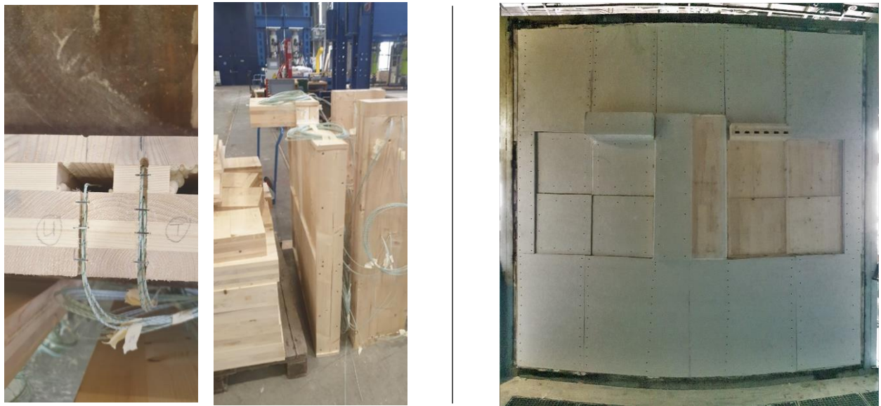
Abbildung 33: Fertigung der Prüfkörper (links) und Ansicht der feuerzugewandten Seite nach Einbau aller Prüfkörper in die Öffnung des Wandprüfofens (rechts)
