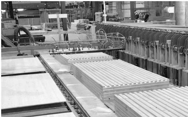
5. Schritt: Verkleben der BSP-Grundelemente mit den 2-lagigen Elementen aus Funktions- und Decklagen
