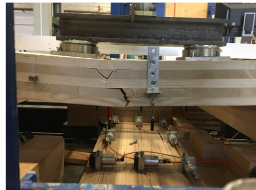
Abbildung 112: Biegezugversagen der Platten aus [53]
