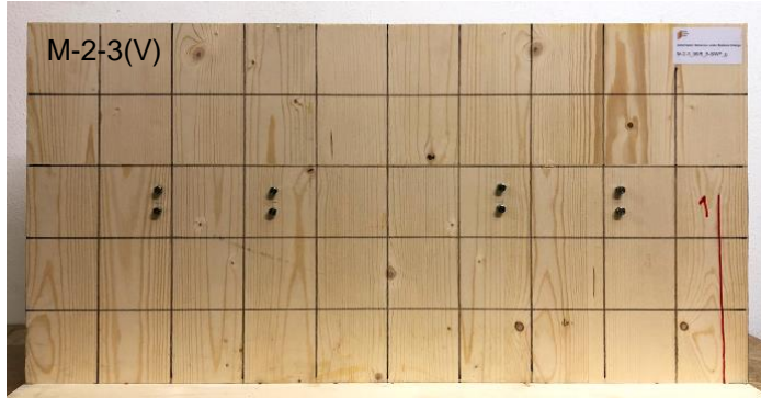
Abbildung 26: Exemplarisches Rissbild in der Außenlage der Serie M-2-3 (V) nach Phase 3
