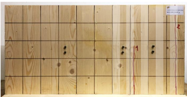
Abbildung A5: Rissbild Prüfkörper M-2-2
