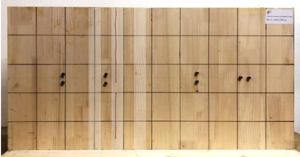
Abbildung A4: Rissbild Prüfkörper M-1-3 (V)
