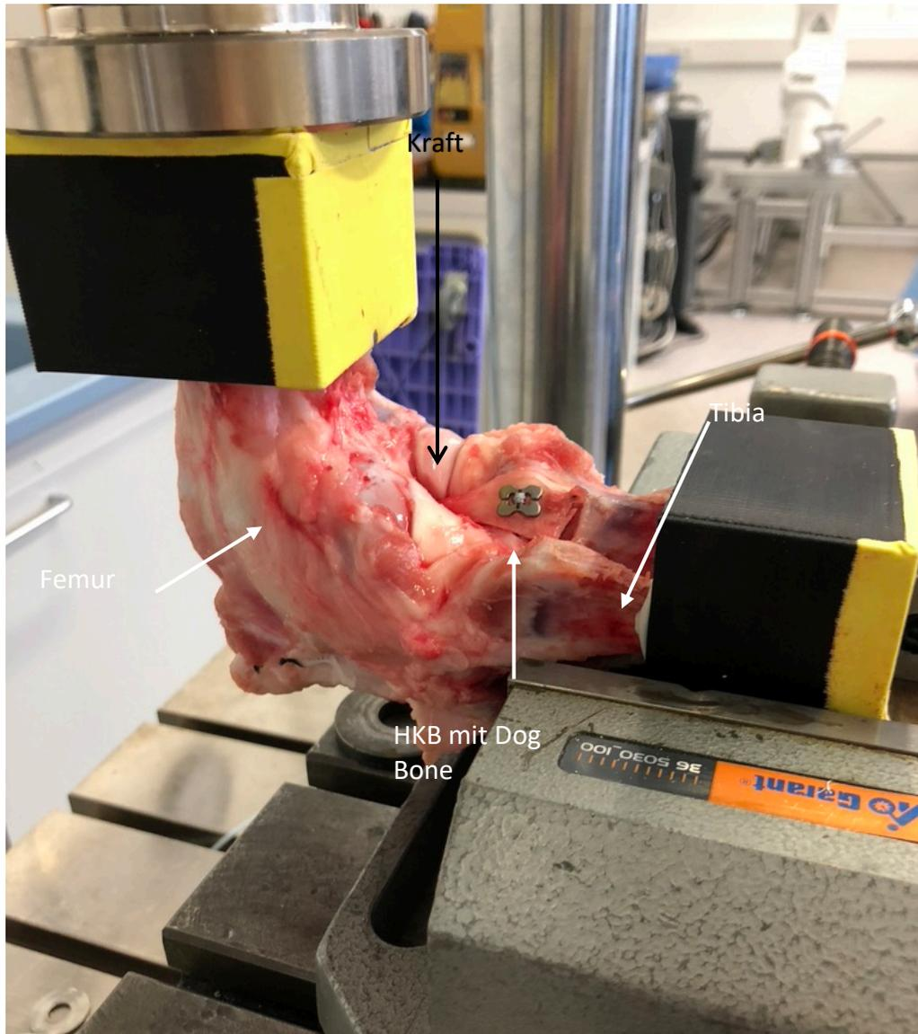
**Abbildung 14** In der Prüfmaschine eingespannte Probe mit beweglichem Femur und fixiertem Unterschenkel.
