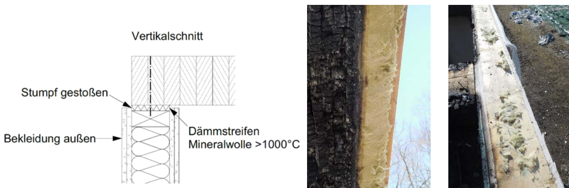
Abb. 16: V4 - Bauteilanschluss – Decke - Wand 3
