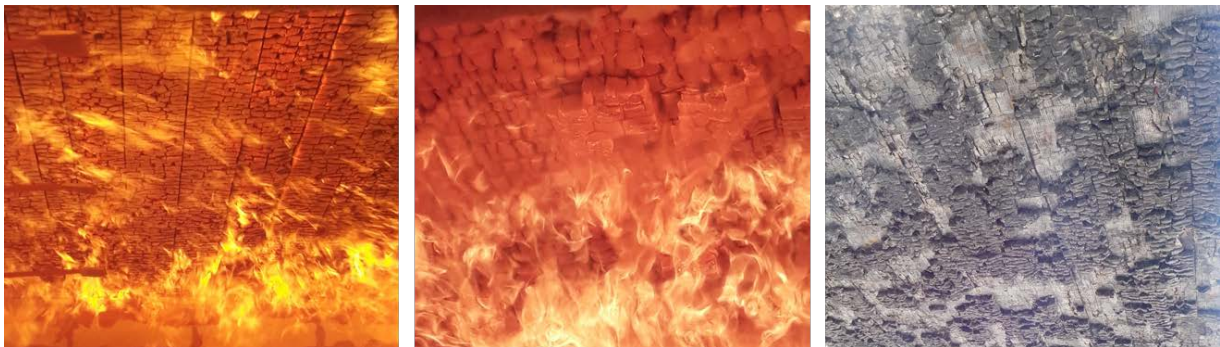
Abb. 3: Brandversuch an einem Brettsperrholzdeckenelement, mit partiellem Abfall der Holzkohle [4]
