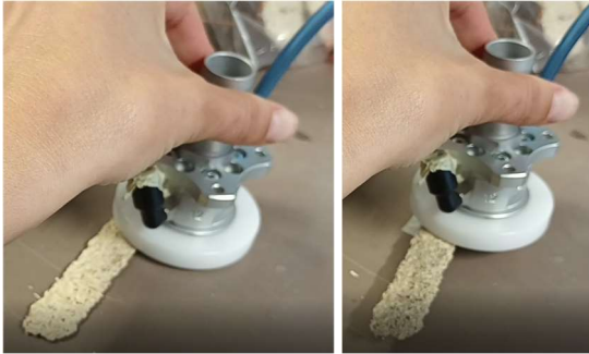
Abbildung 5-6: Aufnahme der Platte am Rand des Saugnapfes (rechts) Verschieben der Platte nach Anheben in Richtung Mittelpunkt des Saugnapfes (links)
