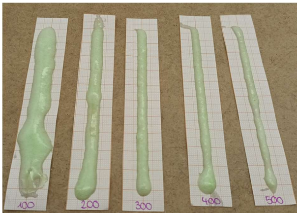
Abbildung 6-8: Auftragsbild der Klebstoffraupen nach dem Aushärten
