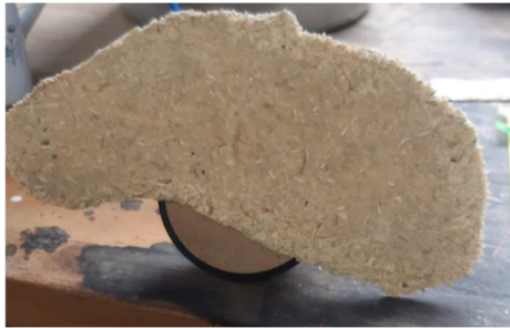
Abbildung 5-2: Saugplattengreifer mit MDF-Platte bei Teilflächenbelegung
