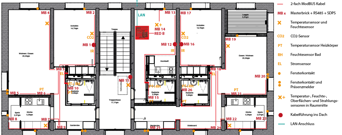
Abbildung 93 Aktueller Stand des Messplans mit Datentransfer via Modbus-Kommunikation
