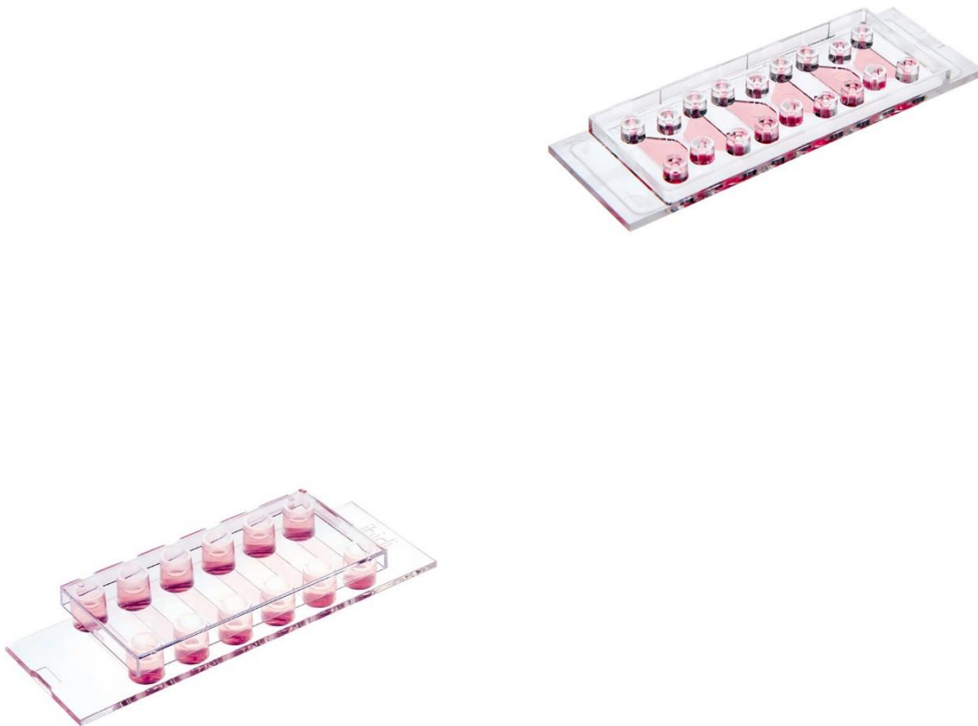
Abb. 12: Verwendete Migrationskammern für unidirektionale Migration (links) für je 6 Proben und bidirektionale Chemotaxis (rechts) für je 3 Proben
