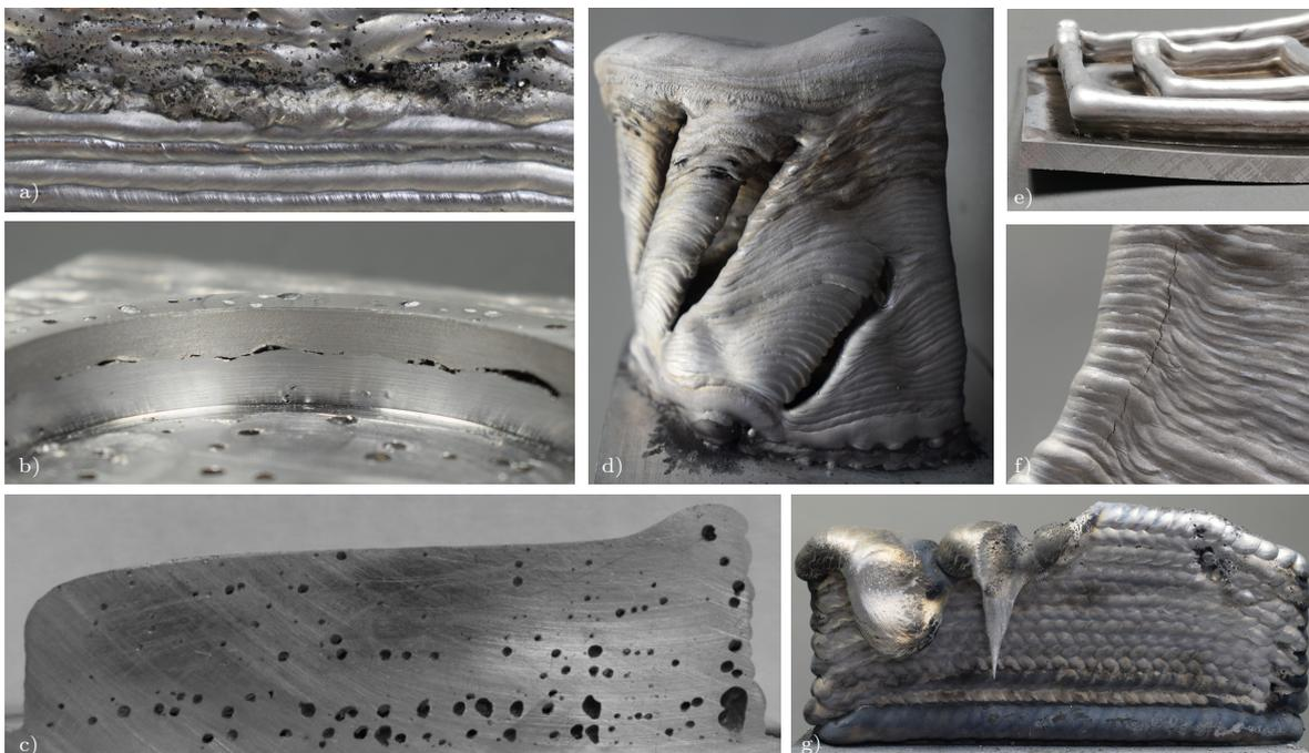
**Abbildung B.1:** Fotos von Defekten beim WAAM-Prozess für Aluminiumlegierungen: a) Oxidation und Schlackeeinschlüsse, b) Bindefehler, c) Porosität und Formabweichung [P5], d) Humping-Effekt, Unstetigkeit und Oxidation [P8], e) Verzug, f) Riss und g) Durchschweißung
