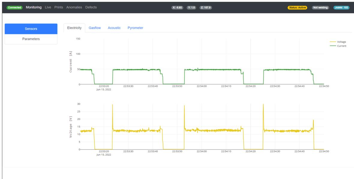
**Abbildung A.2:** Ansicht der Benutzeroberfläche zur Darstellung der Sensordaten. Es sind die gemittelten Strom- und Spannungsdaten für einen mehrlagigen Druck zu sehen. Über die Nutzung von Tabs können verschiedene Sensoren angewählt werden. Im oberen Bereich der Ansicht sind Elemente des Systemkontexts, die aktuelle Position des TCPs sowie Schaltknöpfe zum Wechseln der Ansicht dargestellt.
