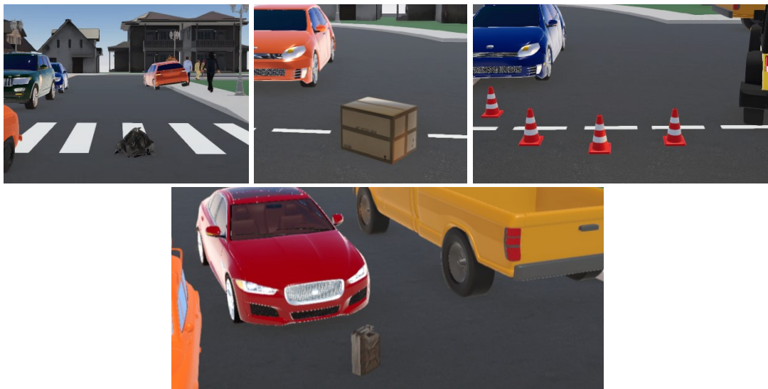
Abbildung 7.12: Nicht überfahrbare Hindernisse, die nicht innerhalb der Straße überfahren werden können. Links oben: Müllsack, Mitte oben: Paket, Rechts oben: Absperrung aus Leitkegeln, unten: Kanister vor dem Egofahrzeug.
