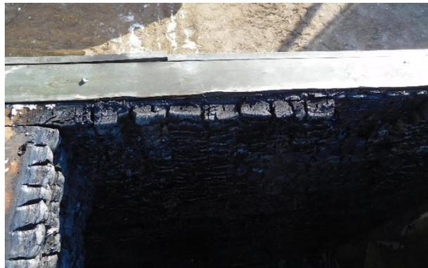
Bild 11 V4 - Bauteilanschluss – Decke an Wand 1
