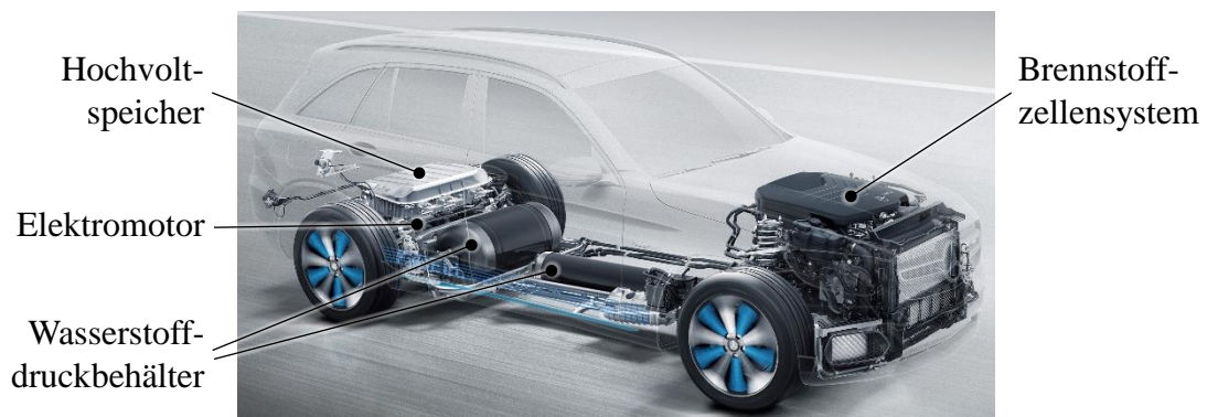
Abb. 1-1: Beispiel für den Antriebsstrang eines aktuellen Brennstoffzellenfahrzeugs dargestellt an einem Mercedes Benz GLC F-Cell [18].
