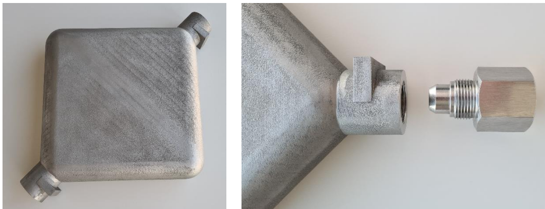
Abb. 4-22: Additiv gefertigter Prototyp eines zugverstrebt Druckbehälters in Stahlbauweise aus Werkzeugstahl 1.2709 (links) und Behälteranschluss (rechts).
