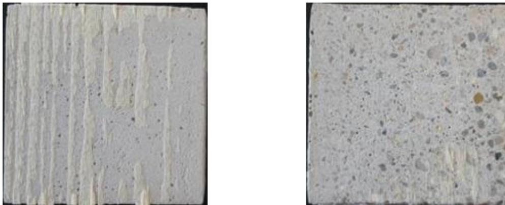
a) Betonseite der Scherfläche A von Prüfkörper 28      b) Betonseite der Scherfläche A von Prüfkörper 30
