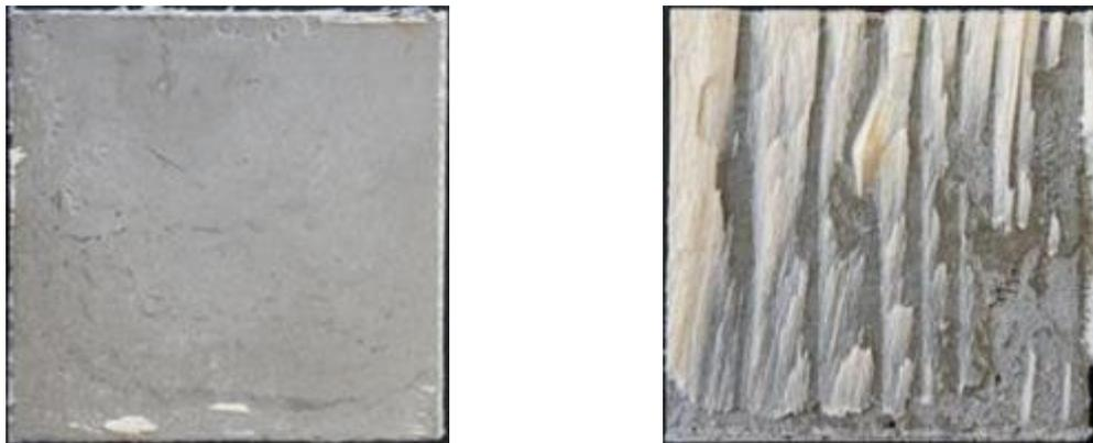
a) Betonseite der Scherfläche B von Prüfkörper 65      b) Betonseite der Scherfläche A von Prüfkörper 49
