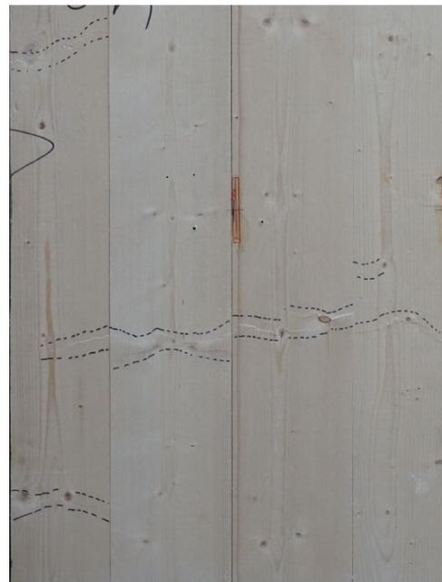
b) V\_D\_30\_10\_2 – duktiler Bauteilversagen
