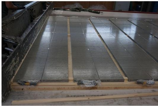
a) Eingelegte Betonplatten in Rohelement
