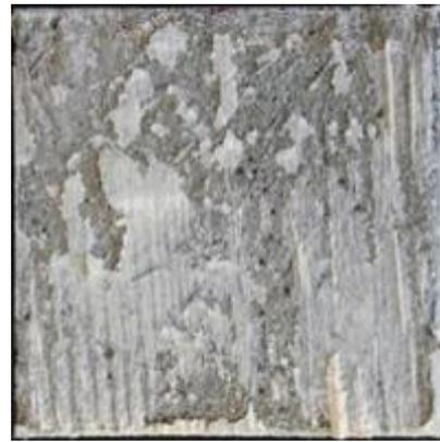
a) Betonseite der Scherfläche B von Prüfkörper 6
