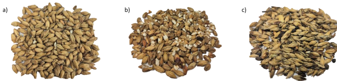
Abbildung 3.52 Malz Avangard vor SORTEX Reinigung (a), als saubere Batch (b) und als aussortierter Abputz (c).
