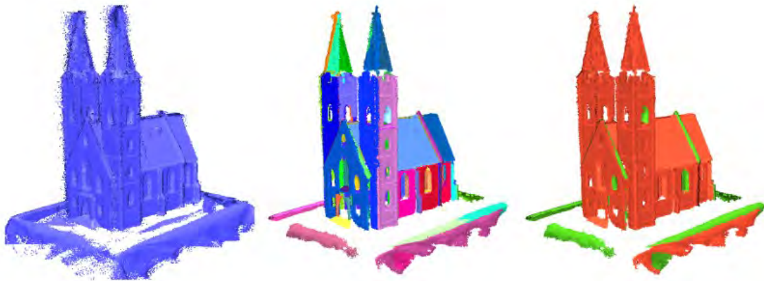
Abbildung 2-5: Flächensegmentierung mit RANSAC. Erste Spalte: Punktwolke. Zweite Spalte: Segmentierte Flächen. Dritte Spalte: Flächen nach Typ koloriert (Schnabel et al. 2007)
