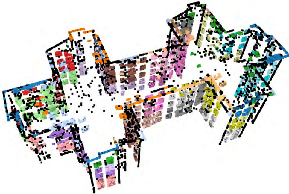
Abbildung 4-9: Ergebnis des DBSCAN-Clustering der Fensterpunkte
