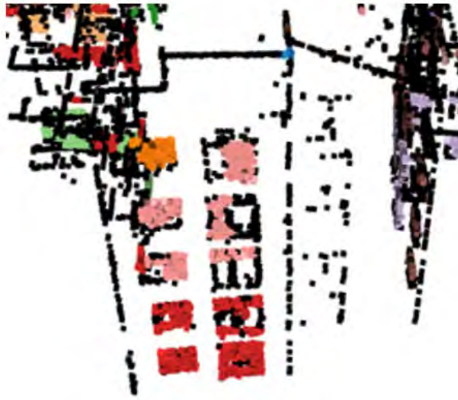
Abbildung 4-8: Fenstererkennung: Clustering der Fensterpunkte bei zu kleinem eps-Wert
