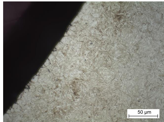
Detailaufnahme Randzonengefüge Zahnfuß – Restaustenit und Martensit
