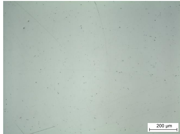
Detailaufnahme Reinheitsgrad im ungeätzten Querschliff (auffälligster Bereich); Mangansulfide
