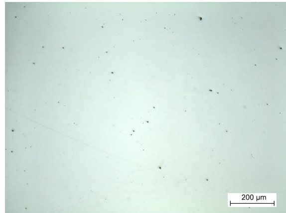
Detailaufnahme Reinheitsgrad, ungeätzt, Oxide und Mangansulfide
