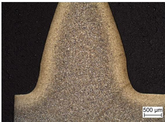
Übersicht Zahngefüge (geätzt), gleichmäßiger Übergang vom Rand- zum Kerngefüge
