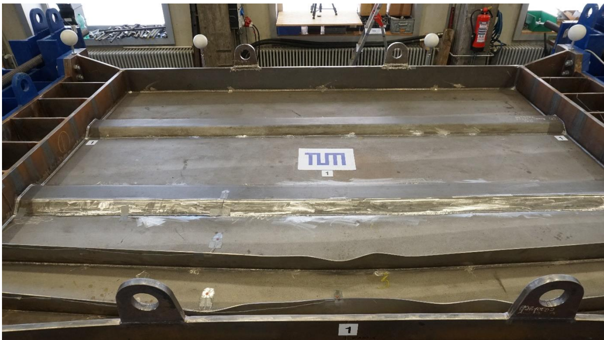
Abbildung A 17: Versagen Versuchskörper D1 mit mehrwelligen Beulen der Längssteifen
