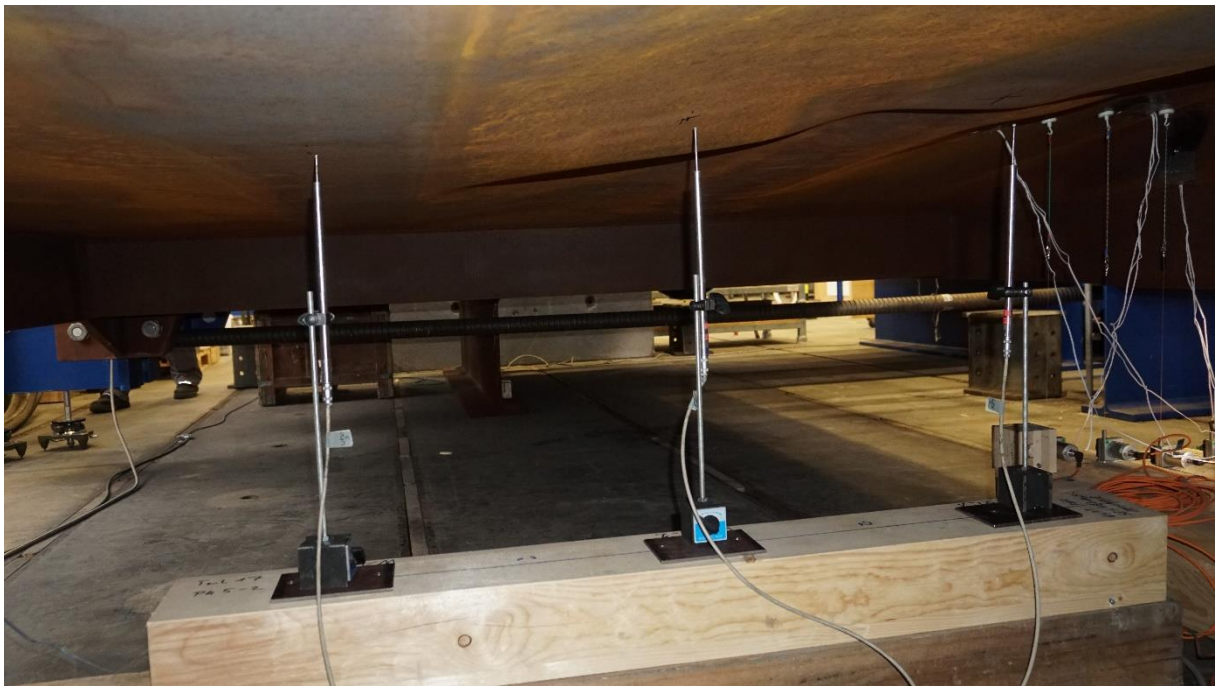
Abbildung A 13: Wegaufnehmer und Dehnungsmessung unterhalb des Prüfkörpers (Position nach Abbildung 4-9 und Abbildung 4-12)
