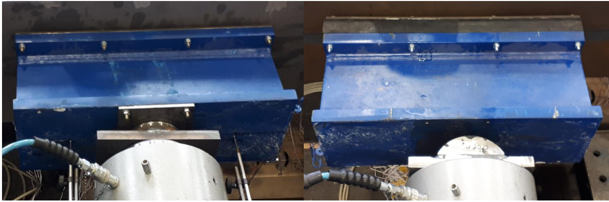
Abbildung A 4: Lasteinleitung mit Kalottenlager (links) und Wippe (rechts)
