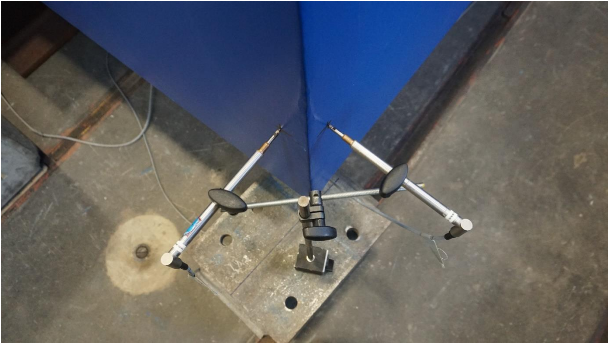
Abbildung A 14: Wegaufnehmer zur Kontrolle der Verschiebung des Prüfstandes jeweils an den Ecken des Prüfstandes
