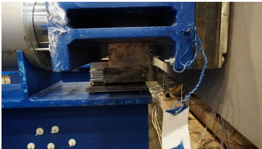
Abbildung A 5: Abmessung und Bild des Kalottenlagers
