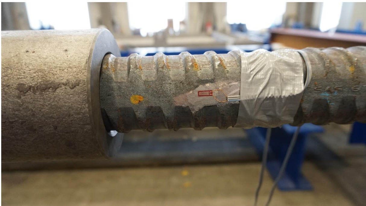
Abbildung A 9: Messung der Dehnung an den Zugstangen (Position nach Abbildung 4-11)
