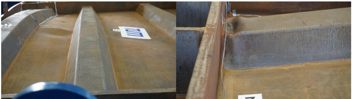
Abbildung A 19: lokale Beulen Versuchskörper D2
