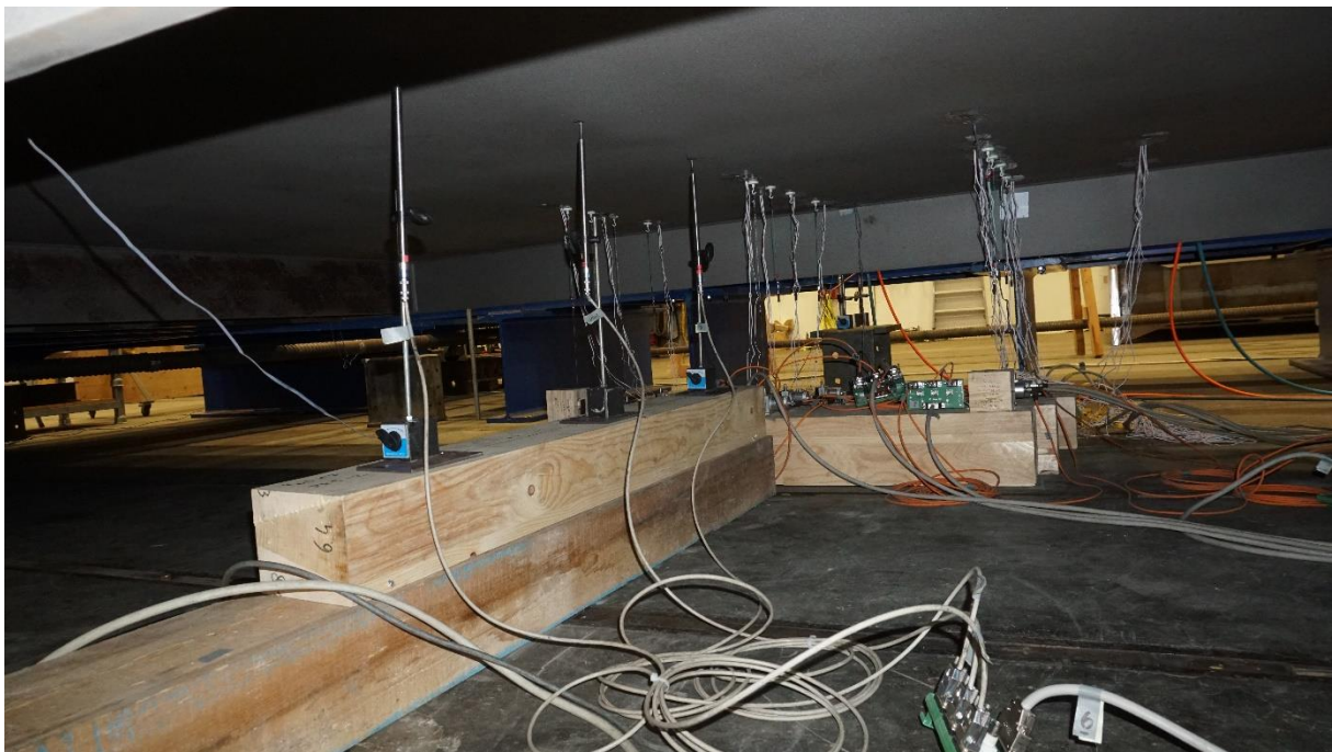
Abbildung A 11: Wegaufnehmer und Dehnungsmessung unterhalb des Prüfkörpers (Position nach Abbildung 4-9 und Abbildung 4-12)
