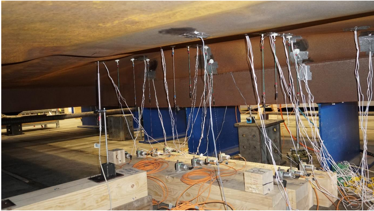
Abbildung A 12: Wegaufnehmer und Dehnungsmessung unterhalb des Prüfkörpers (Position nach Abbildung 4-9 und Abbildung 4-12)
