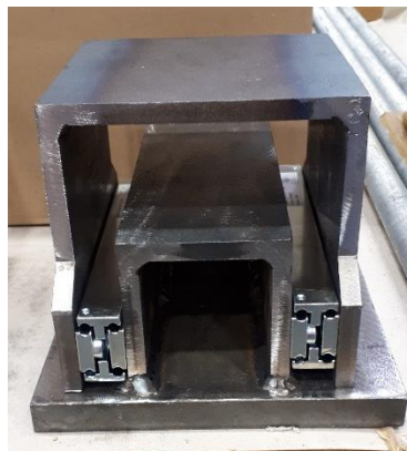
Abbildung A 6: verschiebbliche Lagerung der Lasteinleitungsträger
