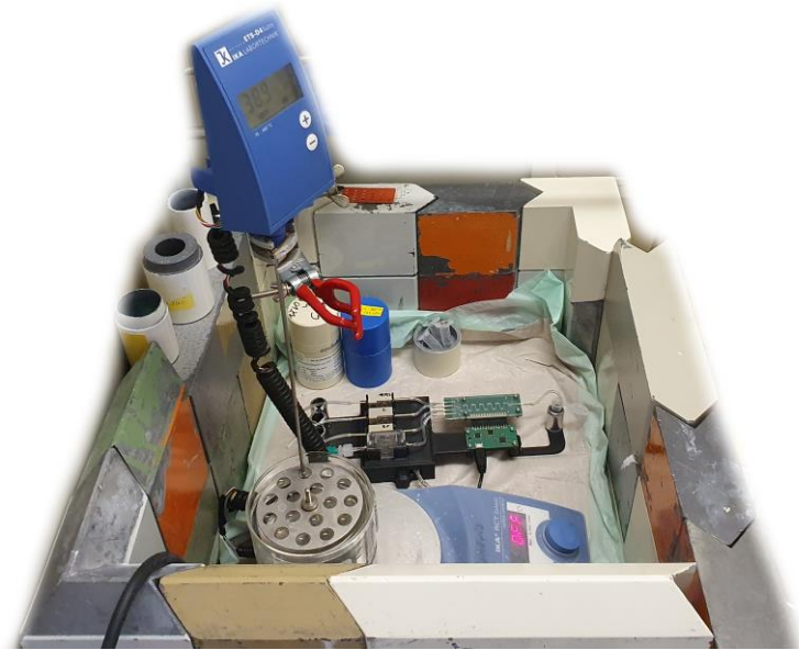
Abbildung 58: Das Dosiersystem (Variante B) in einer Bleiburg, die den Experimentator vor Gammastrahlung schützt. Im Vordergrund das auf 37°C beheizte Wasserbad.
