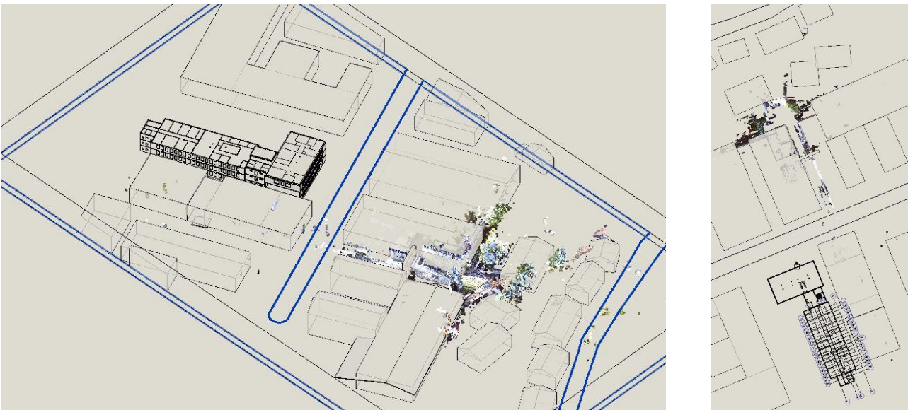
Abbildung 42: Die aufgenommenen 3D-Punktwolken für das BIM Modell.
