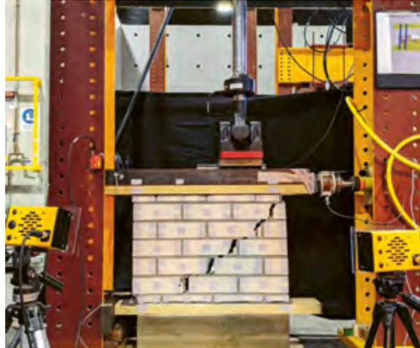
An der UQ führte Tobias Teschemacher Mauerwerksversuche für seine Doktorarbeit durch. **BILD** Tobias Teschemacher
