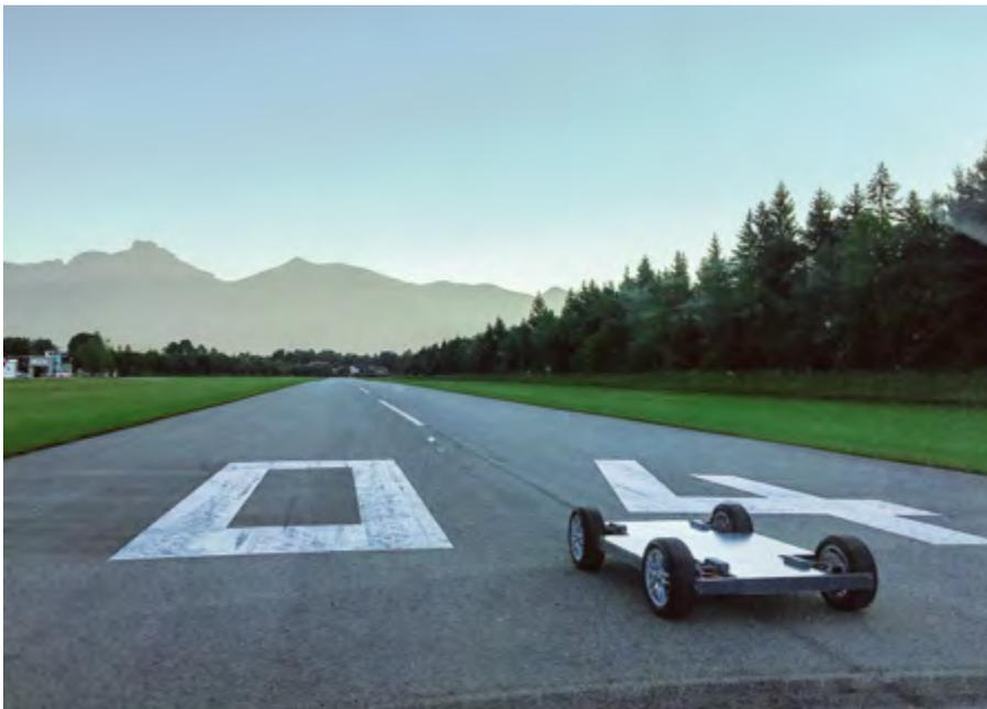
Das Start-up DeepDrive hat eine modulare Plattform für Elektrofahrzeuge entwickelt: Das Herzstück ist ein neu konzipierter, hocheffizienter Antrieb. Er besteht aus zwei Radnabenmotoren mit integrierter Motorsteuerung, welche die Hinterräder antreiben.
