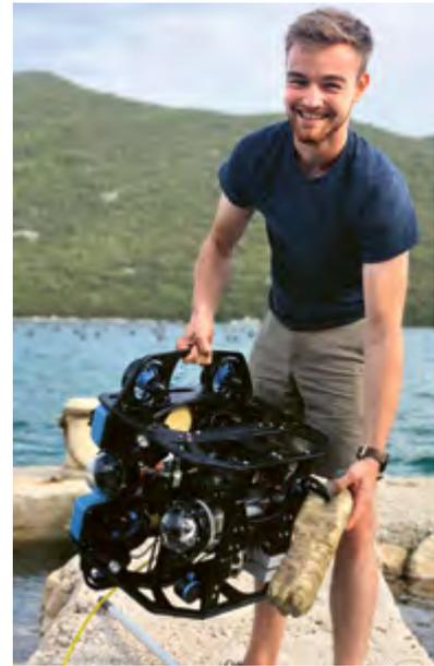
Der Sammelroboter sammelt mithilfe eines Greifers den Müll unter Wasser auf. Größere Teile werden durch einen Korb abtransportiert, der mit dem Schiff verbunden ist.
