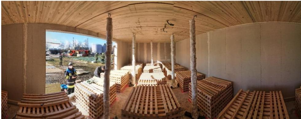
Bild 18: 180° Dronenaufnahme aus dem Inneren des Brandraumes (V3)
