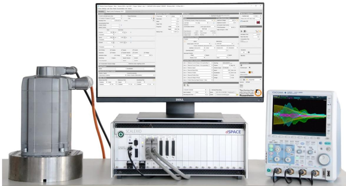
**Bild 3.8** Teststand zur Ansteuerung der Servomotoren
