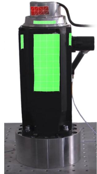
**Bild 2.16** Abklingende Tangentialgeschwindigkeiten des Positionsmessgerätes relativ zum Motorgehäuse mit dazugehörigem Bild der Messauswertung
