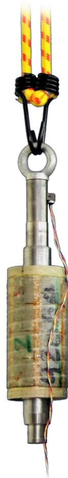
**Bild 2.6** Modalanalyse an einem Rotor
