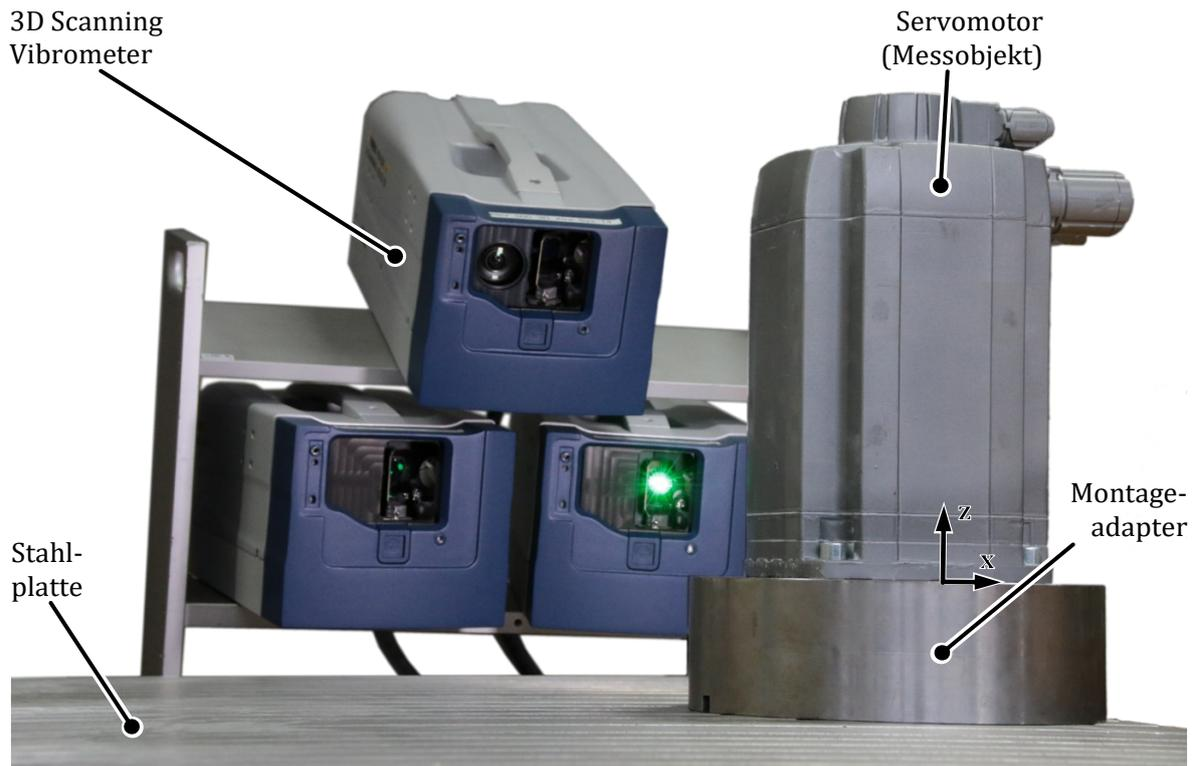
**Bild 2.8** Prinzipieller Messaufbau mit 3D-Laser Scanning Vibrometer
