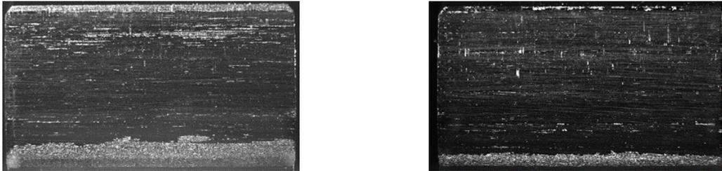
**Bild 7-37: Exemplarische Zahnflankenfotos der Ritzel C-GF 2 (links) und C-GF 3' (rechts) nach Ende des Dauertests mit Praxisschmierstoff B**
