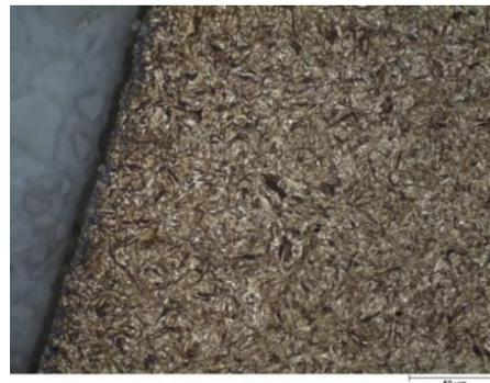
**Bild 6-11: Schliffbild des Randgefüges, Detail (16MnCr5), Maßstab = 50 µm**
