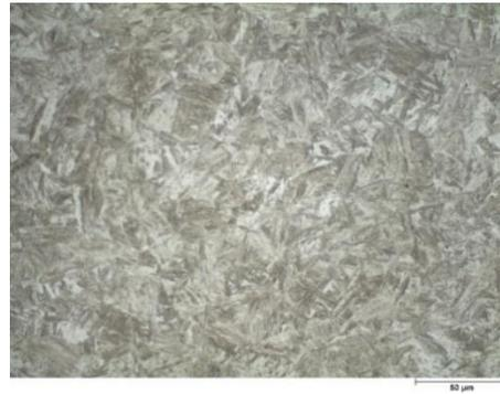
**Bild 6-9: Schliffbild des Kerngefüges, Detail (18CrNiMo7-6), Maßstab = 50 µm**
