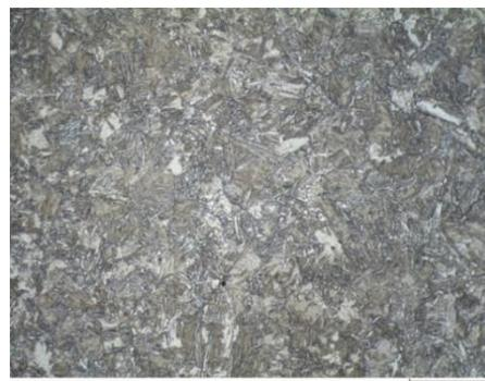
**Bild 6-13: Schliffbild des Kerngefüges, Detail (16MnCr5), Maßstab = 50 µm**
