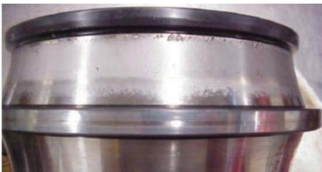
**Bild 2-6: Graufleckigkeit auf der Laufbahn eines Pendelrollenlagers [FAG06]**
