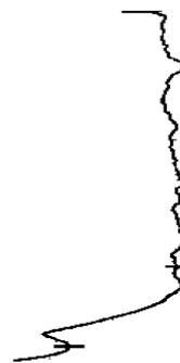
Diese zusätzlichen durch die Schabemarke verursachten Flankenformänderungen sind als Profilformabweichung in einem Messschrieb erkennbar und müssen für die zuverlässige Bewertung der Graufleckentragfähigkeit herausgerechnet werden. [DIN20, Emm93, Liu03]
