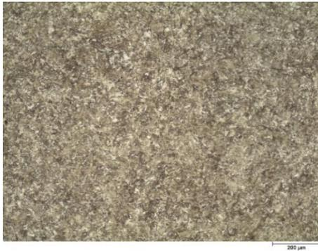
**Bild 6-8: Schliffbild des Kerngefüges, Übersicht (18CrNiMo7-6), Maßstab = 200 µm**
