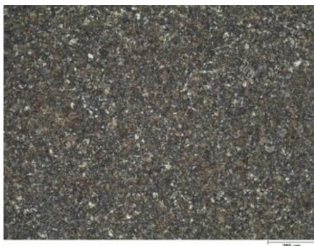
**Bild 6-12: Schliffbild des Kerngefüges, Übersicht (16MnCr5), Maßstab = 200 µm**
