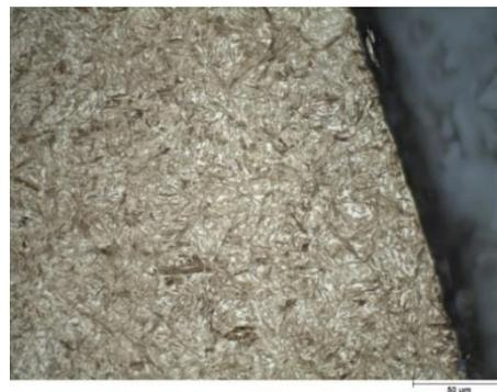
**Bild 6-6: Schlibfbild des Randgefüges, Übersicht (18CrNiMo7-6), Maßstab = 500 µm**
