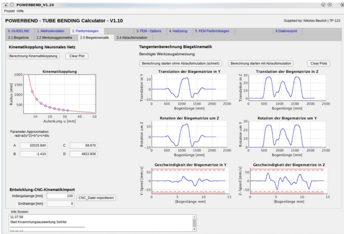
Abbildung 10.1: Benutzeroberfläche zur Auslegung und Simulation des Freiformbiegeprozesses
