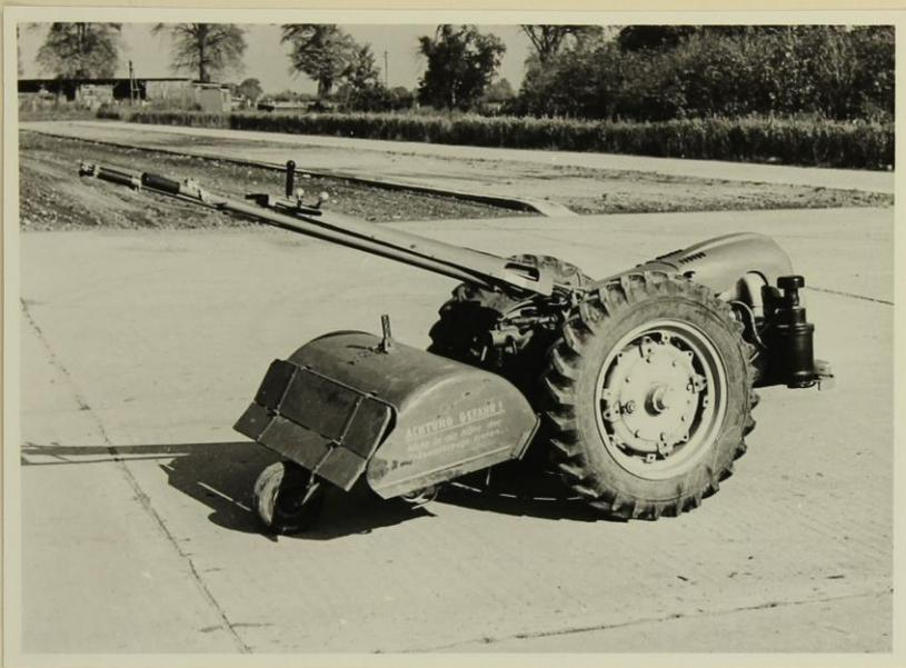
Abb. 1: Einachsschlepper ET 19/9.5
