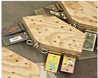
Anpassung der ursprünglichen Rundholzkonstruktion in eine Konstruktion aus flächigen Elementen
