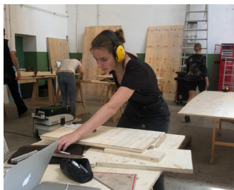
Bau der Fräs- und Bohrschablone
