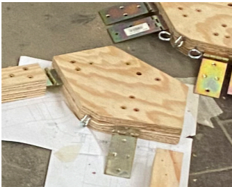
Anpassung der ursprünglichen Rundholzkonstruktion in eine Konstruktion aus flächigen Elementen
