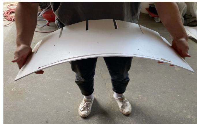
Durchbiegung nach Probezuschnitt
