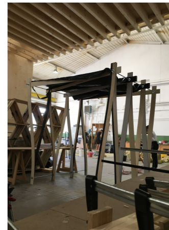
Versuch: Dachhaut innerhalb der Hochpunkte
