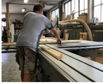
Ablängen der Rundstäbe
