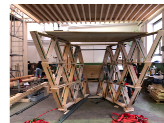
Versuchsaufbau mit Dachelementen
