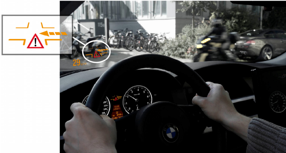
Abbildung 5: Warnsymbol im Head-Up Display und Instrumenten-Kombi bei visuell-auditiv-haptischer Warnung vor einem vorfahrtsberechtigten Motorrad.
