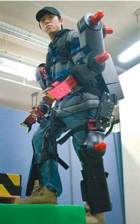
So ausgerüstet, steuert der Bauarbeiter gewaltige Greif- und Hebe- prothesen, die seine Bewegungen ausführen.
