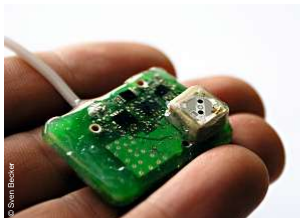
Dieses Implantat mit integriertem pO_2 -Sensor wird erfolgreich in einem Projekt zur Überwachung der Knochenheilung am Allgemeinen Krankenhaus Wien verwendet.
