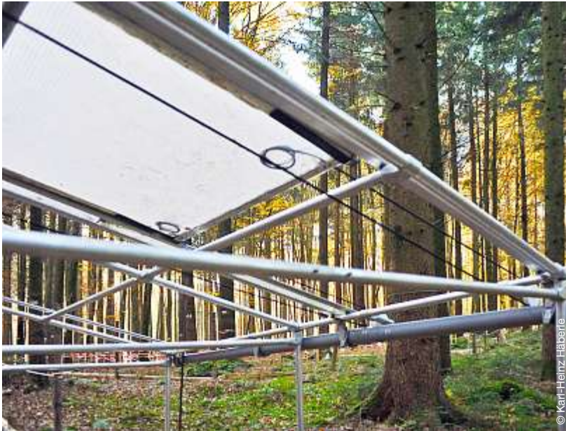
Dachkonstruktion auf sechs der zwölf Parzellen im Kranzberger Forst zum Ausschluss des natürlichen Niederschlags. Die Dächer werden automatisch nur bei Regen geschlossen.
