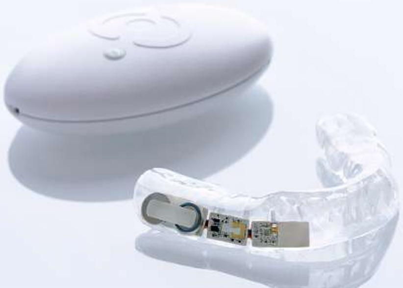
Die intelligente Zahnschiene dient als Erprobungsträger für die Technologieplattform für intelligente Implantate.
