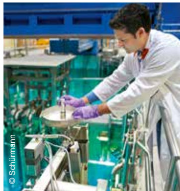
Die Kapselbestrahlungsanlage dient zur Herstellung von Radioisotopen.
