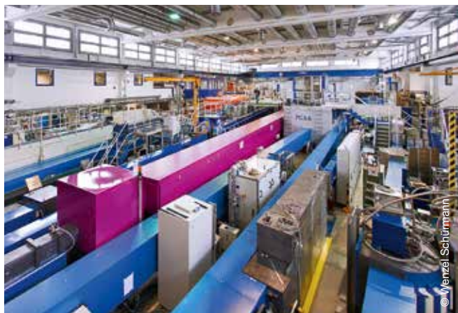
Das Instrument »Prompte Gamma Aktivierungs-Analyse« (PGAA) in der Neutronenleiterhalle erzeugt den intensivsten Neutronenstrahl der Welt. Damit wird vor allem die Elementarzusammensetzung von Objekten untersucht.
