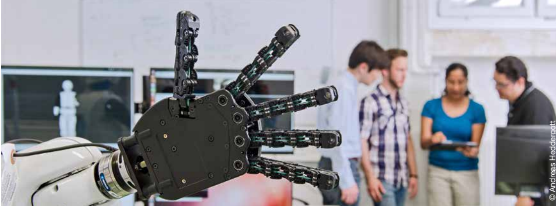
Fünf Kilogramm kann jede Hand des ersten humanoiden Roboters (H-1) des Instituts für Kognitive Systeme der TUM tragen. H-1 soll einer der ersten humanoiden Roboter werden, der mit seinem ganzen Körper fühlen kann.
