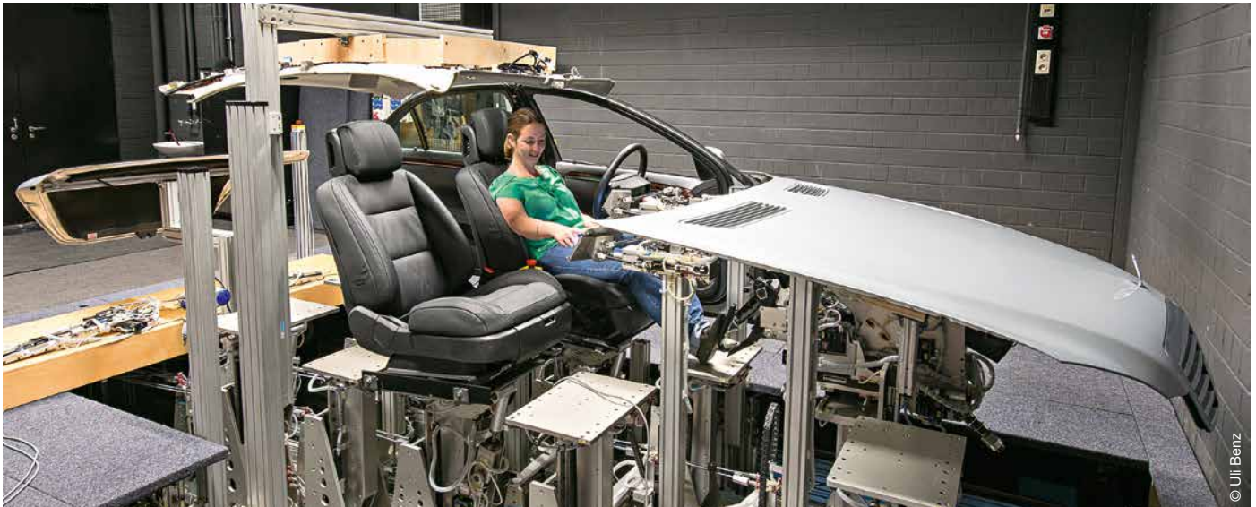
Der modulare Ergonomieprüfstand kann im Handumdrehen umgerüstet werden.
