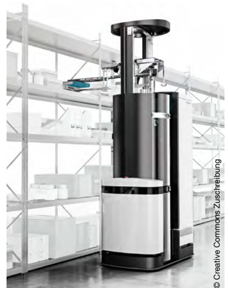
Der TORU Cube von Magazino greift gezielt einzelne Objekte aus einem Regal.
