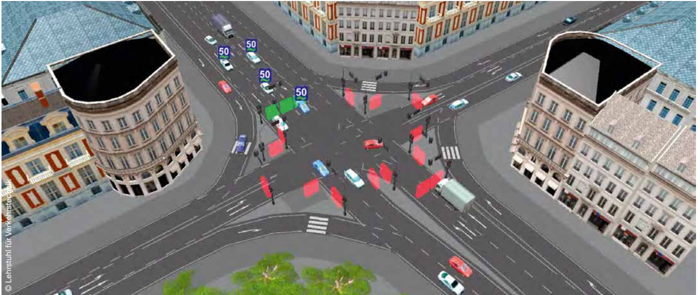
© Lehrstuhl für Verkehrstechnik Simulationsstudie: Knotenpunkt mit Ampel-Fahrzeug-Kommunikation
