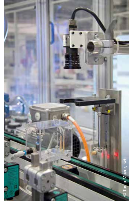
Automatisierte Prüfstation für LED-Lampen, die automatisch konfiguriert und aufgabenorientiert programmiert wurde.
